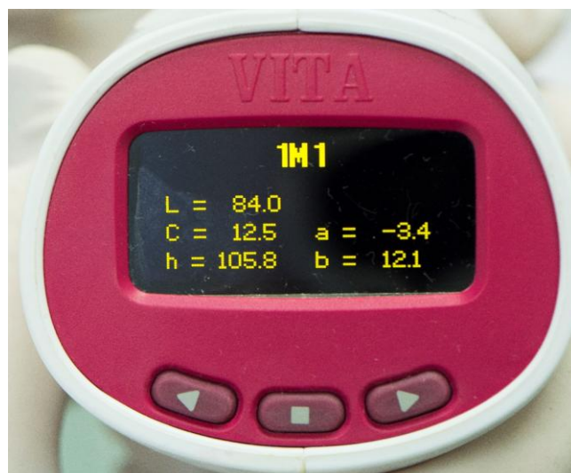
Slika 19. Spektrofotometrom dobivene vrijednosti L*, C*, h, a* i b* dva tjedna nakon izbjeljivanja. Preuzeto s dopuštenjem autora: prof. dr. sc. Dubravka Knezović Zlatarić.
