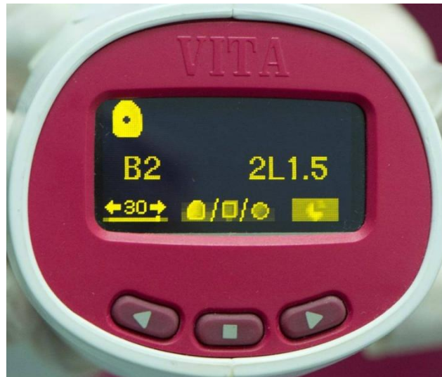
Slika 9. Spektrofometrijsko mjerenje boje gornjeg desnog središnjeg sjekutića, izraženo prema VITA classical A1-D4 ® ključu boja i 3D Master ključu. Preuzeto s dopuštenjem autora: prof. dr. sc. Dubravka Knezović Zlatarić.
