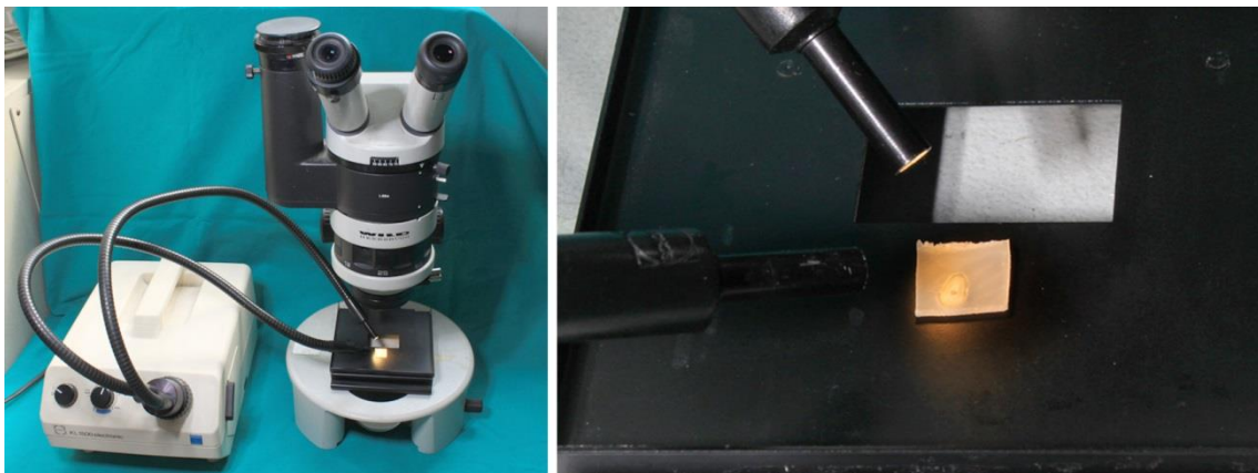
Slika 18. Pregledavanje uzoraka stereomikroskopom nakon push-out testiranja
