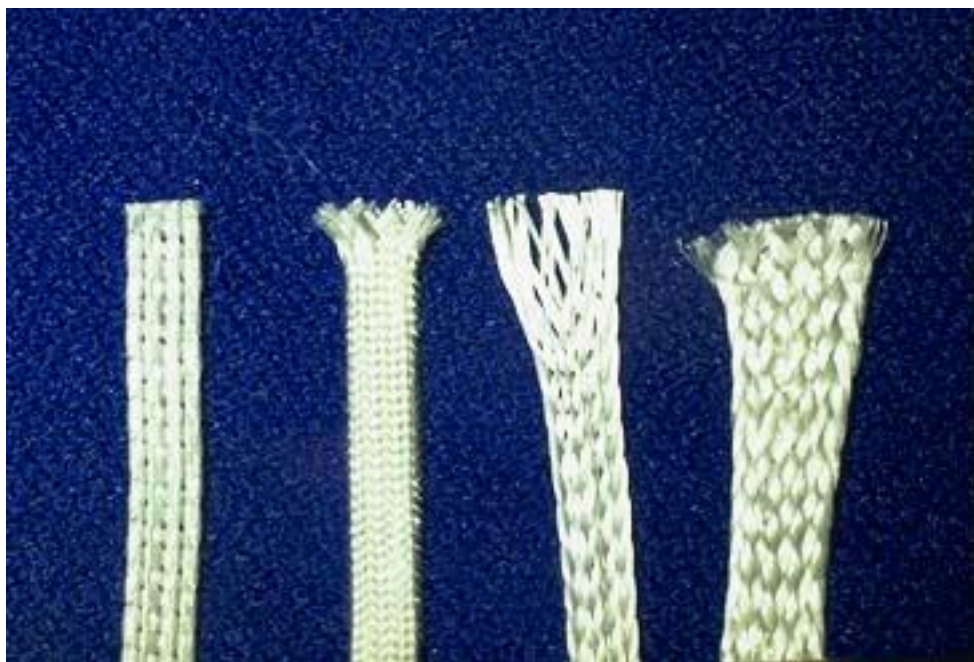
Slika 5. Polietilenskim vlaknima pletene poliesterske vrpce.
