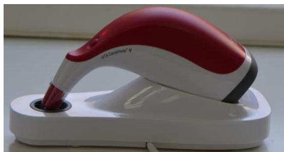
Slika 7. VITA Easyshade V na pločici za kalibriranje
