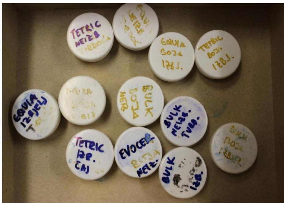
Slika 8. Uzorci za mjerjenje boje i mikrotvrdoće
