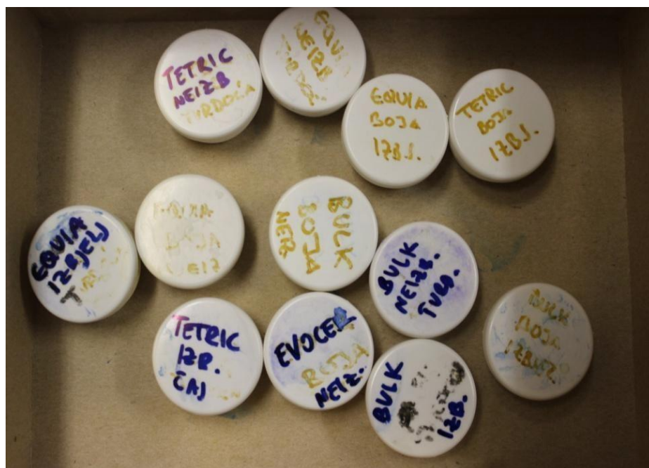
Slika 8. Uzorci za mjerenje boje i mikrotvrdoće
