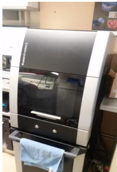
**Slika 63.** Glodalica za CAD/CAM izradu
