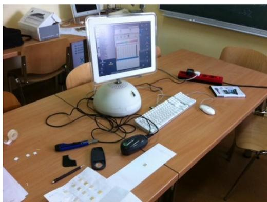
**Slika 66.** Postupci mjerenja uzoraka zubnih keramika na spektrofotometru DTP 20 Pulse, X-Rite povezanim sa softverom
