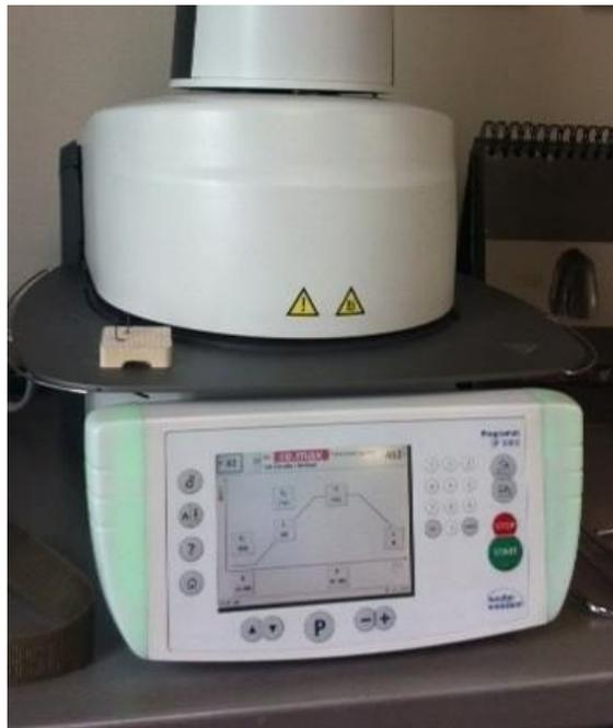
**Slika 60.** Peć za postupak toplo-tlačne izrade (Programat EP 5000 Ivoclar Vivadent, Schaan, Lihtenštajn)
