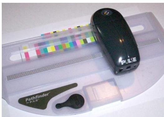
**Slika 67.** Spektrofotometar DTP 20 Pulse, X-Rite
