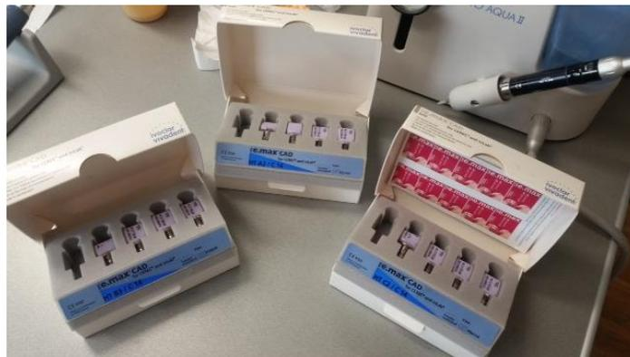
**Slika 62.** Presinterirani blokovi za strojnu izradu
