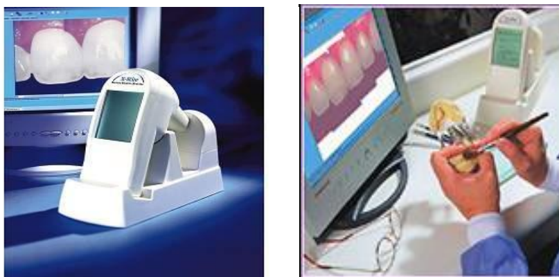
Slika 44. Shade Vision kolorimetar (X-Rite,Grandville,SAD ) (preuzeto iz 169)
