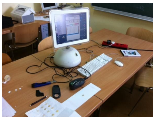
Slika 66. Postupci mjerenja uzoraka zubnih keramika na spektrofotometru DTP 20 Pulse, X-Rite povezanim sa softverom
