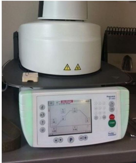
Slika 60. Peć za postupak toplo-tlačne izrade (Programat EP 5000 Ivoclar Vivadent, Schaan, Lihtenštajn)
