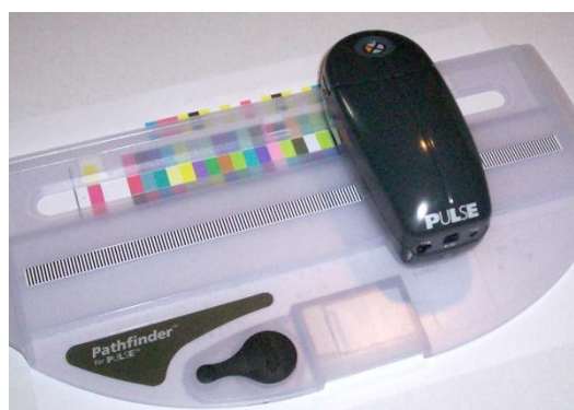
Slika 67. Spektrofotometar DTP 20 Pulse, X-Rite
