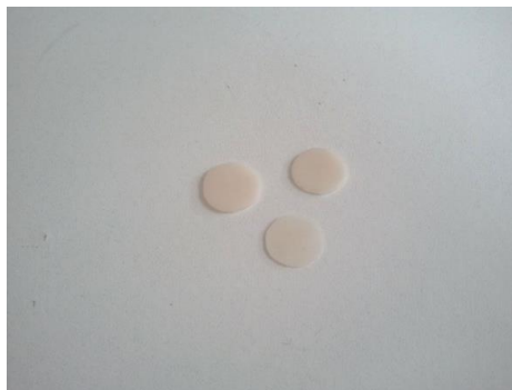
Slika 70. Gotove pločice obložne keramike IPS e.max Ceram (Ivoclar Vivadent) – boja A2; promjer 11 mm i debljine 0,3 mm, 0,5 mm i 0,8 mm
