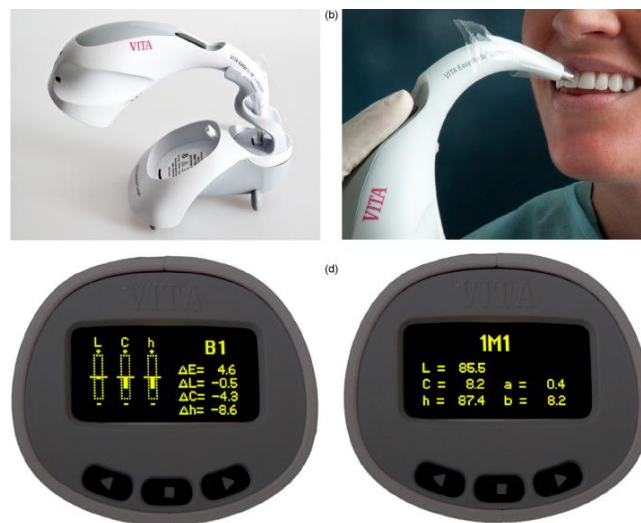
Slika 44. Dentalni spektrofotometar VITA Easyshade Compact (VITA Zahnfabrik) za točkasto mjerenje boje (promjer vrha 5 mm) i prikaz izmjenjenih parametara boje (preuzeto iz 143)
