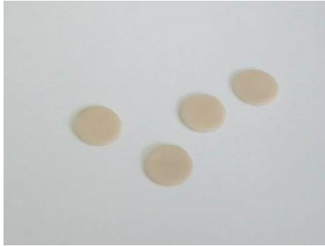
Slika 68. Gotove pločice \text{Li}_2\text{S}_2 jezgrene keramike IPS e.max Press
