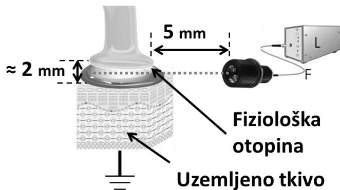
Slika 26. Shematski prikaz konfiguracije za mjerjenje spektra u volumenu u slučaju kada je ispunjen fiziološkom otopinom
