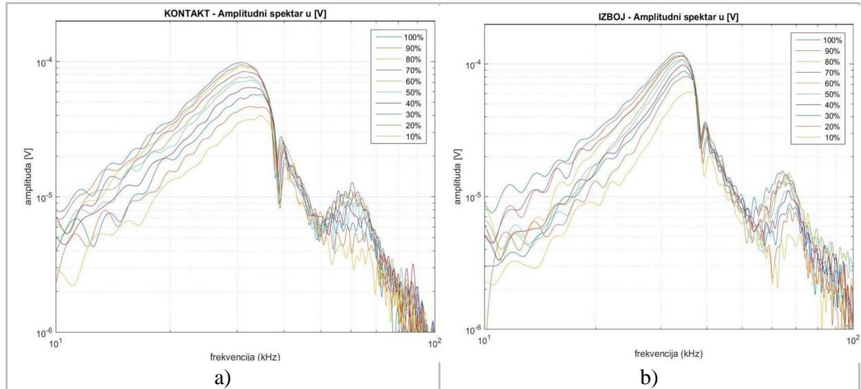
Slika 51. Prikaz promjene maksimuma amplitudnog spektra mjerenog napona promjenom intenziteta (10 – 100%) pri: a) kontaktom izboju i b) izboju kroz zrak
