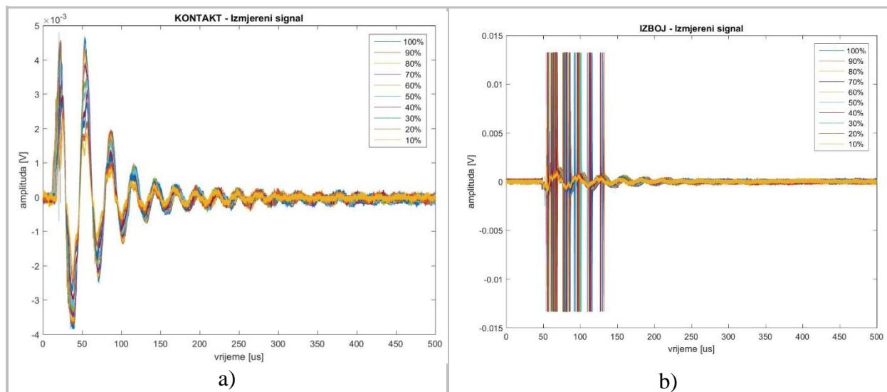
Slika 35. Prikaz valnih oblika napona zabilježenih prilikom mjerjenja magnetskog polja elektrode u *loop* anteni pri: a) kontaktnom izboju i b) izboju kroz zrak
