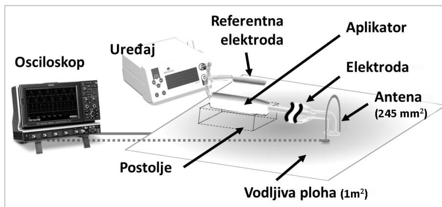
Slika 29. Konfiguracija korištena u mjerjenjima magnetskog polja
