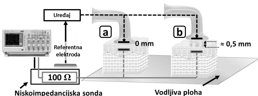
Slika 36. Konfiguracija korištena za mjerjenje efektivnog napona i struja u tkivu pri: a) kontaktnom izboju i b) izboju kroz zrak
