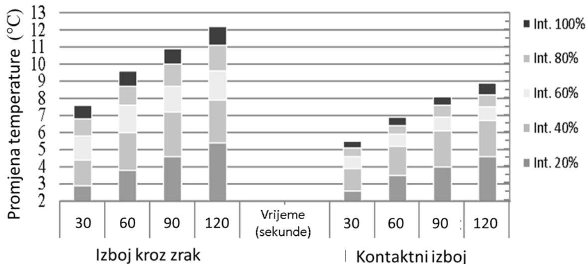
Slika 63. Promjena temperature ( $\Delta T = T_1 - T_0$ ) za pojedini intenzitet (20, 40, 60, 80 i 100%) i vrijeme izloženosti (30, 60, 90 i 120 sekundi) ukazuje na značajno veće povećanje temperature na površini tkiva pri izboju kroz zrak u odnosu na kontaktni izboj.
