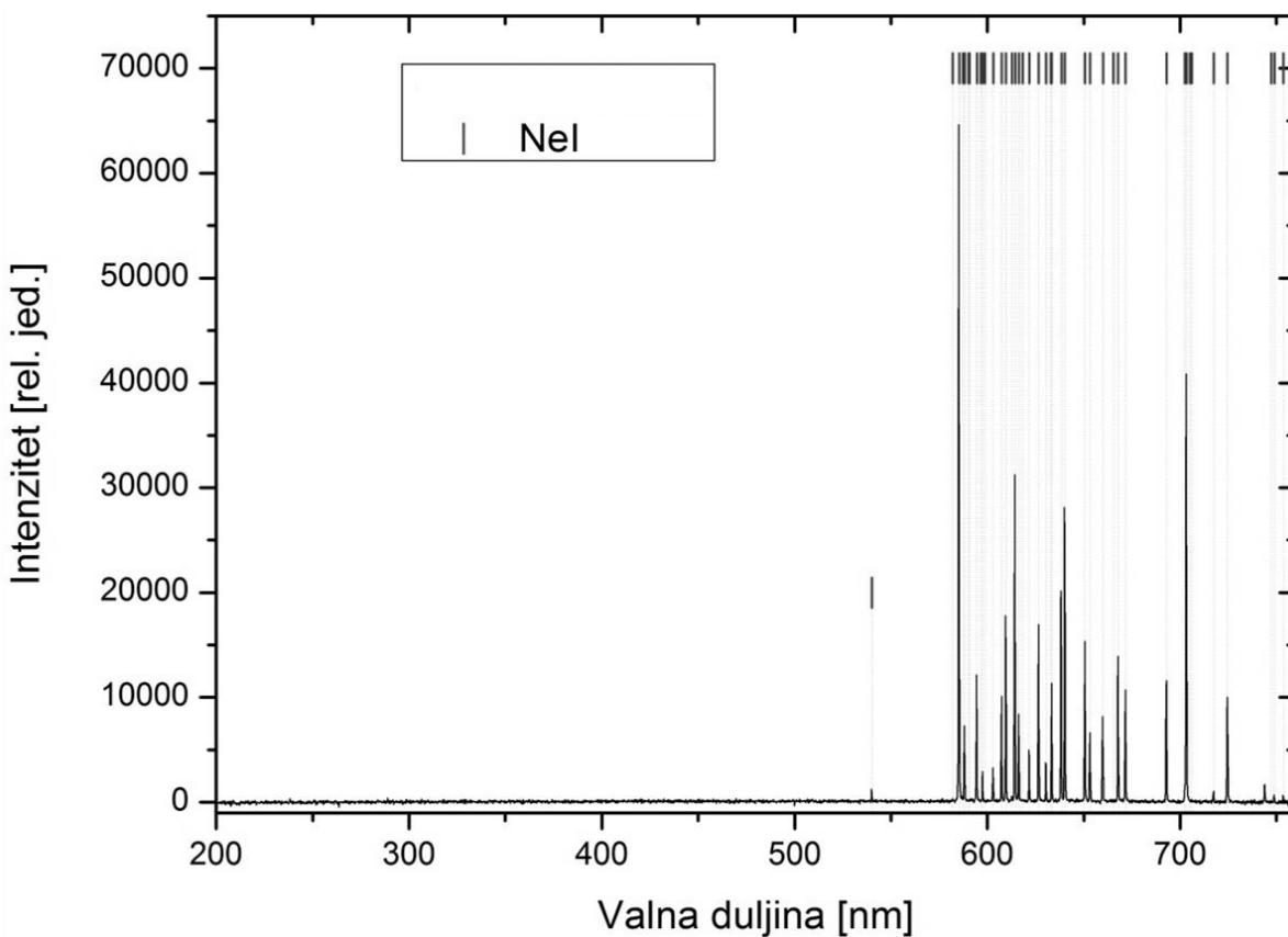
Slika 41. Emisijski spektar elektrode mјeren optičkim vlaknom izravno usmјerenim u aktivnu površinu elektrode bilježi isključivo atomske spektralne linije neona (optičko područje od 200 do 750 nm)
