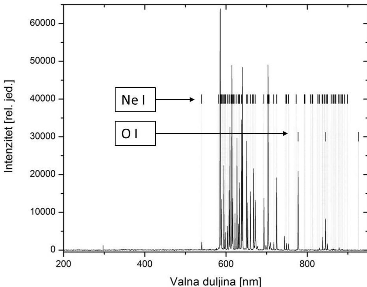
Slika 42. Emisijski spektar elektrode mjerен optičkim vlaknom izravno usmjerenim u aktivnu površinu elektrode. Bilježe se atomske linije neon-a i linije atoma kisika (prikazano područje od 200 do 950 nm)
