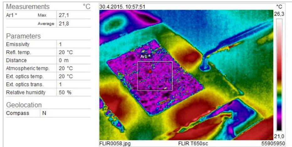
Slika 37. Prikaz određivanja reflektirane temperature određivanjem prosječne vrijednosti temperature na površini objekta koji u infracrvenom spektru zrači difuzno (aluminijска фолија)
