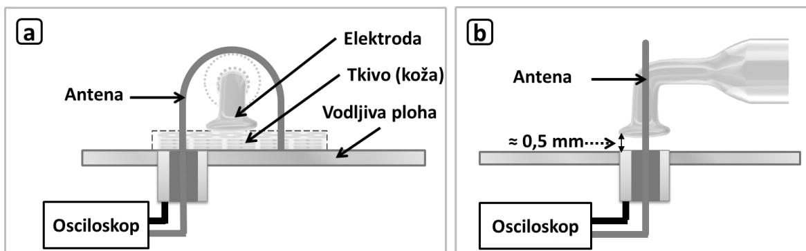
Slika 33. Odnosi aktivne plazma-elektrode i antene pri mjerenu magnetskog polja tijekom:
