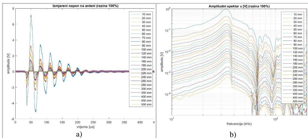
Slika 32. Mjerenje električnog polja: a) valni oblik napona izmijerenog na monopol anteni, b) amplitudni spektar napona izmijerenog na monopol anteni
