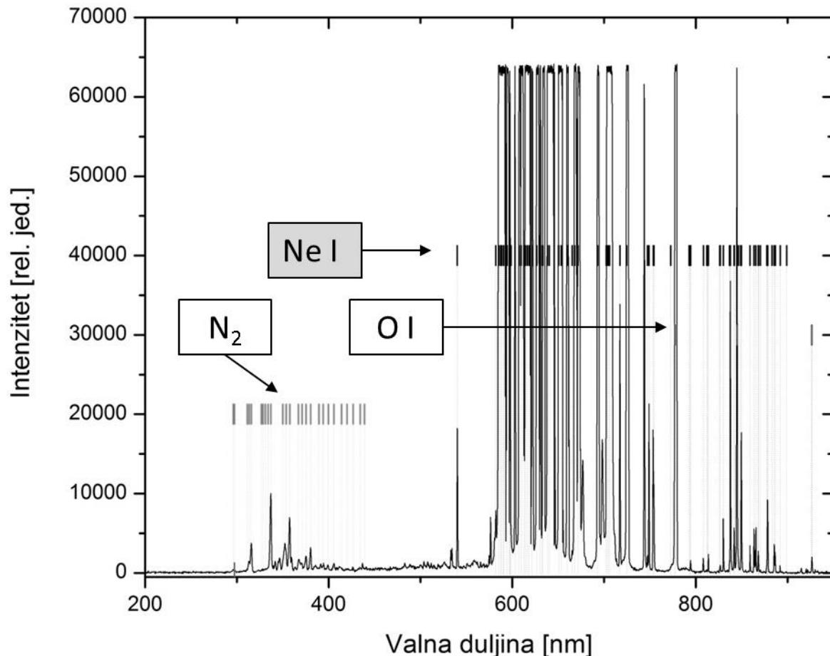
Slika 46. Spektralne linije zabilježene u slučaju izboja kroz zrak na malu površinu žice gdje je optičko vlakno s lećom usmjerenog uz samu površinu elektrode zbog čega dolazi do zasićenja spektralnih linija neutralnog atoma neon-a (Ne I). Tom prilikom bilježe se linije atoma kisika na 926 nm (prikazano područje od 200 do 950 nm)
