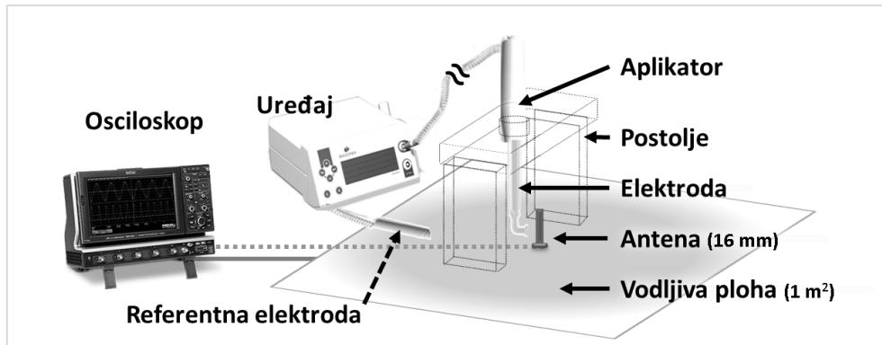
Slika 28. Konfiguracija korištena za mjerjenje električnog polja
