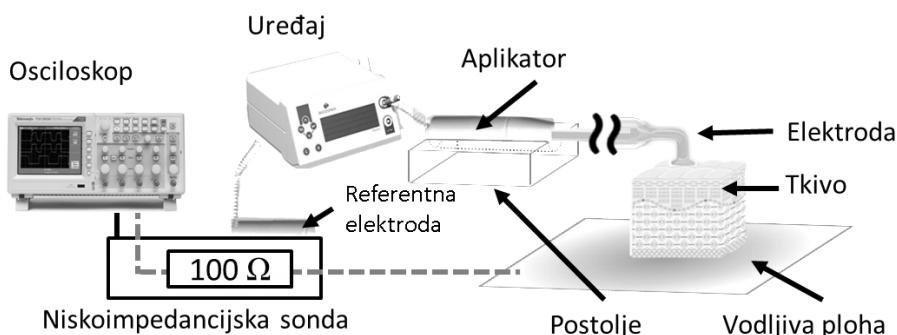
Slika 30. Konfiguracija korištena za mjerjenje efektivnih struja kroz tkivo
