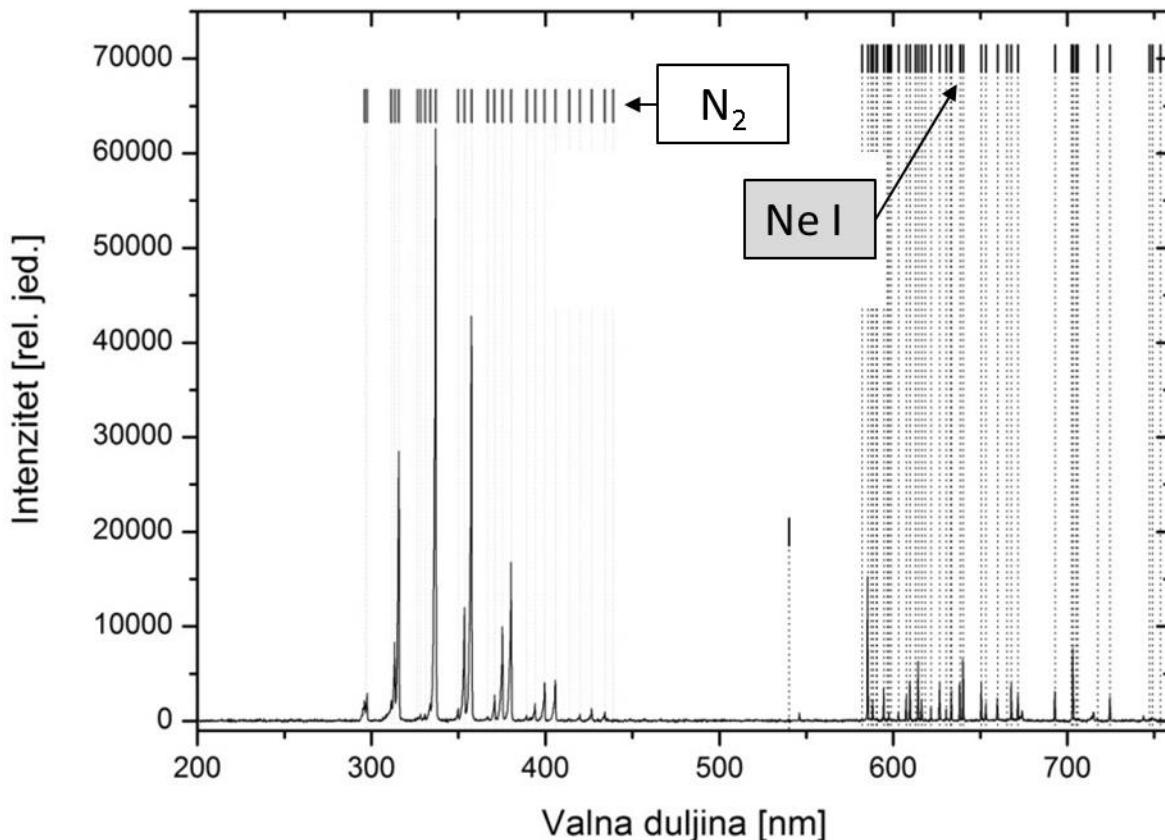
Slika 43. Emisijski spektar zabilježen u volumenu koji je omeđen aktivnom površinom elektrode i površinom tkiva u kojem se javljaju mikroizboji gdje dio svjetlosti dolazi iz tog volumena a dio iz same elektrode (optičko područje od 200 do 750 nm)
