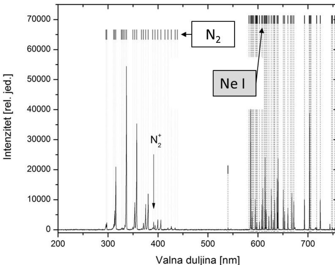
Slika 44. Emisijski spektar zabilježen prilikom izboja na malu površinu žice (površine  $0,8 \text{ mm}^2$ ) u kojem se uz spektralne linije neutralnog atoma neon (Ne I) i molekule dušika ( $\text{N}_2$ ) javlja i linija iona dušikove molekule ( $\text{N}_2^+$ )
