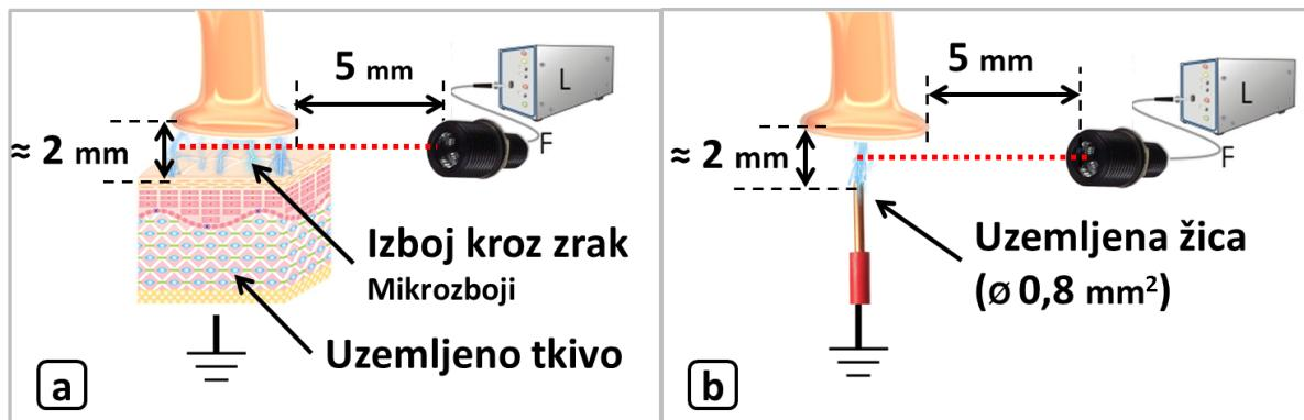
Slika 25. Shematski prikaz konfiguracije za mjerjenje spektara izboja kroz zrak:
