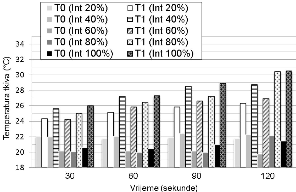
Slika 61. Temperatura ciljne površine na tkivu u slučaju kontaktnog izboja prije ( $T_0$ ) i nakon zahvata ( $T_1$ ) u ovisnosti o intenzitetu i vremenu izloženosti
