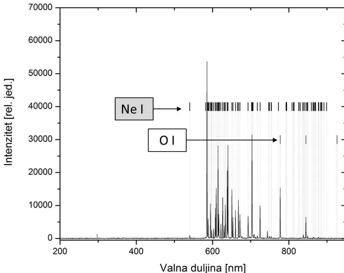
Slika 48. Spektralne linije neutralnog atoma neona te atoma kisika (O I) zabilježene pri kontaktnom izboju kroz tekući medij na površini uzorka tkiva
