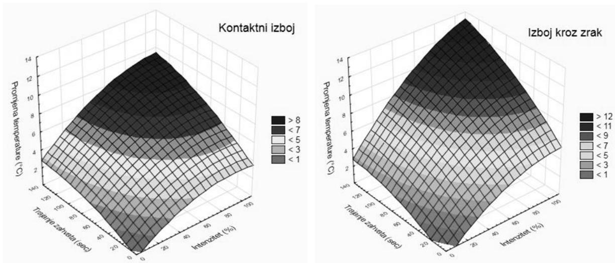
Slika 65. Predikcija promjene temperature ( $^{\circ}\text{C}$ ) intenzitetom i trajanjem zahvata kvadratnim regresijskim modelom za kontaktni izboj i izboj kroz zrak
