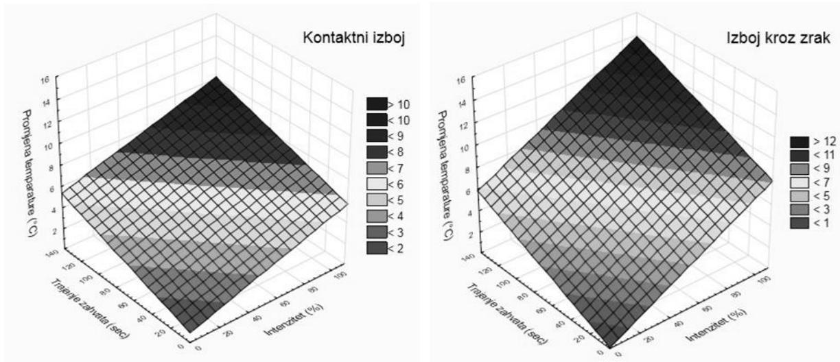
Slika 64. Predikcija promjene temperature ( $^{\circ}\text{C}$ ) intenzitetom i trajanjem zahvata linearnim regresijskim modelom za kontaktni izboj i izboj kroz zrak
