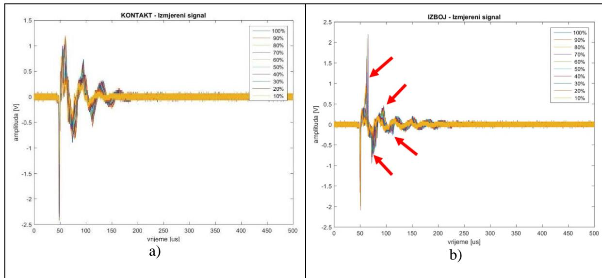
Slika 55. Zabilježeni valni oblik napona u slučaju (a) kontaktnog izboja i (b) izboja kroz zrak prilikom kojeg dolazi do formiranja mikroizboja koji se uočavaju na osciloskopu kao oštreti nanosekundni šiljci (strelice)
