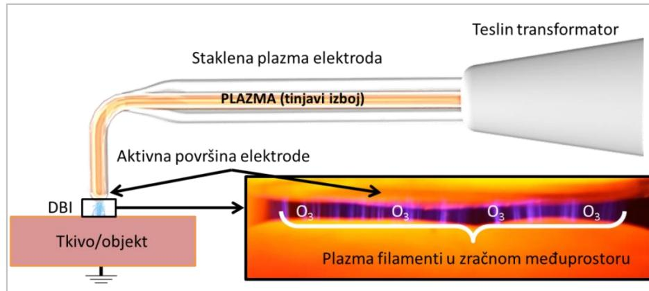
Slika 9. Prikaz sustava u kojem se putem *Teslinog transformatora* i plazma-elektrode postiže dielektrični barijerni izboj u terapijskom polju pri čemu se generiraju mikroizboji (hladna atmosferska plazma), a time i ozon
