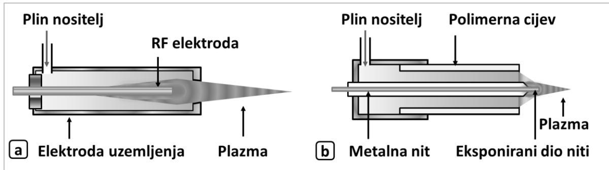
Slika 7. Primjer indirektnih sustava za proizvodnju hladne atmosferske plazme:
