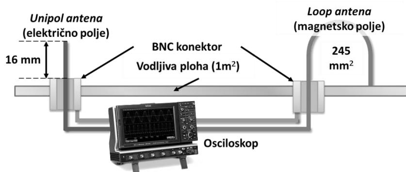
Slika 27. Antene korištene u mjeranjima električnog i magnetskog polja
