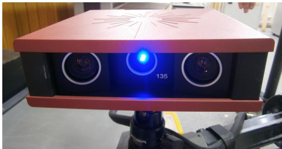
Slika 38. Optički skener ATOS Core 135 (GOMmbH, Braunschweig, Njemačka).
