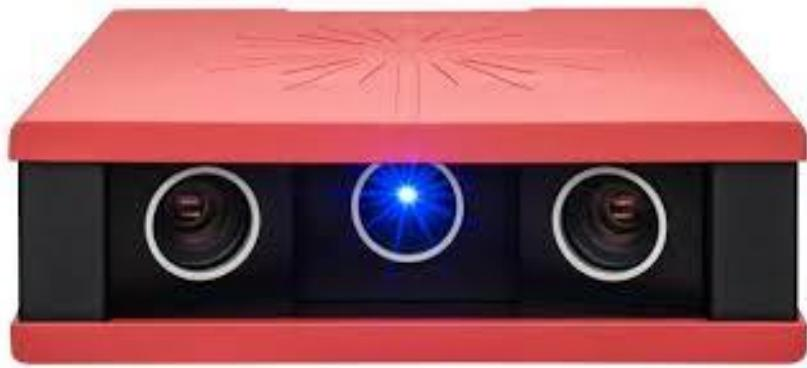
Slika 8. Optički skener ATOS (GOMmbH, Braunschweig, Njemačka).
