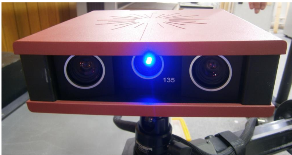
Slika 38. Optički skener ATOS Core 135 (GOMmbH, Braunschweig, Njemačka).
