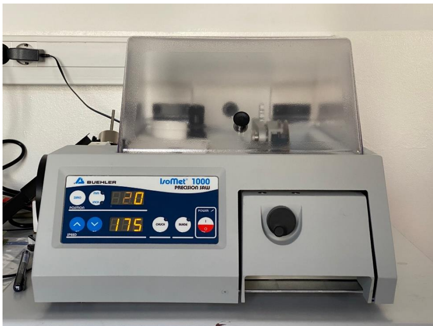
Slika 3.2. Precizna rezalica IZOMET 1000 korištena za pripremu uzoraka
