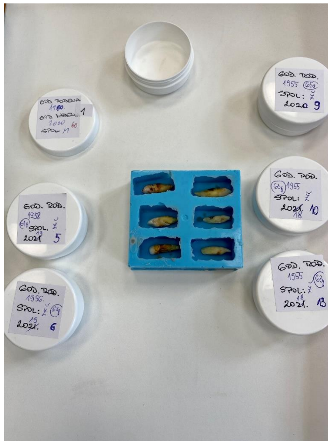
Slika 3.1. Očitani, dezinficirani i posušeni zubi u pripremi za uklapanje u brzovezujući akrilat
