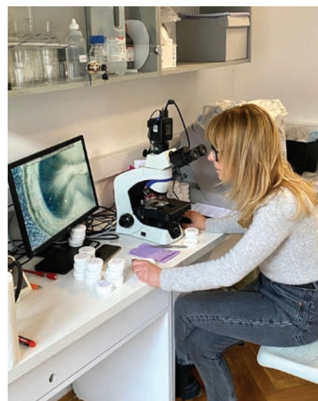
Slika 34. Mjerenje debljine cementa pod mikroskopom
