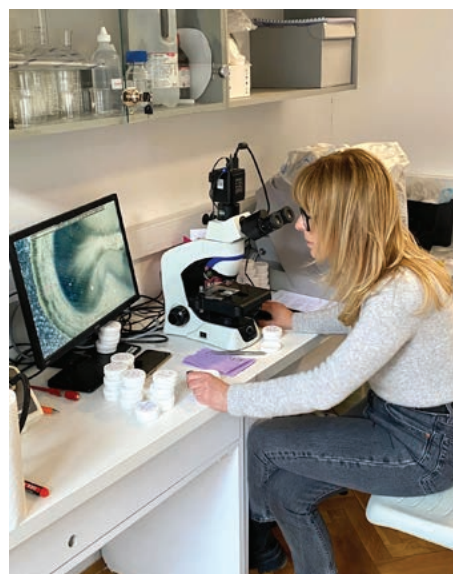
Slika 34. Mjerenje debljine cementa pod mikroskopom
