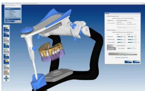
Slika 7. Virtualni artikulator (preuzeto iz (174)).
