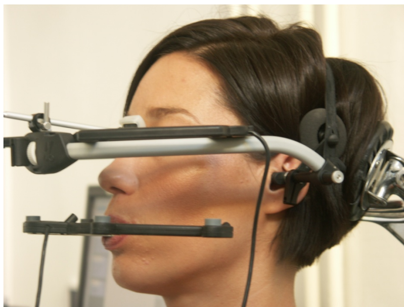
Slika 10. Primjer uređaja za snimanje kretnji donje čeljusti na temelju šest stupnjeva slobode (ultrazvučni princip).
