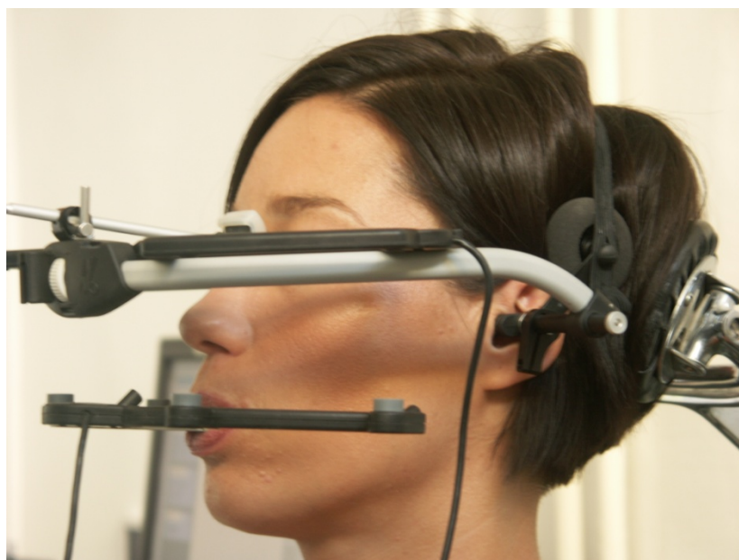
Slika 10. Primjer uređaja za snimanje kretnji donje čeljusti na temelju šest stupnjeva slobode (ultrazvučni princip).
