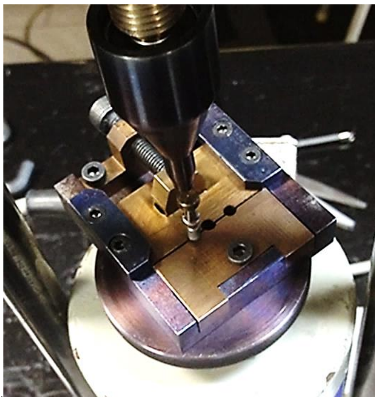
Slika 12. Aplikacija opterećenja na sklop implantata i nadogradnje
