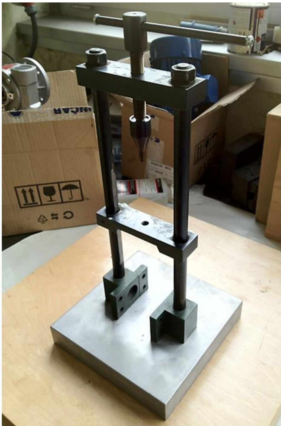
Slika 2. Vretenasta preša korištena kao baza uređaja za opterećenje implantata
