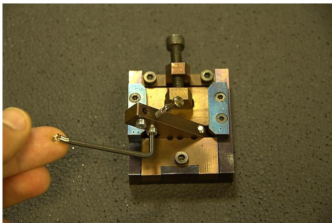
Slika 10. Fiksacijska naprava za primjenu kosih opterećenja
