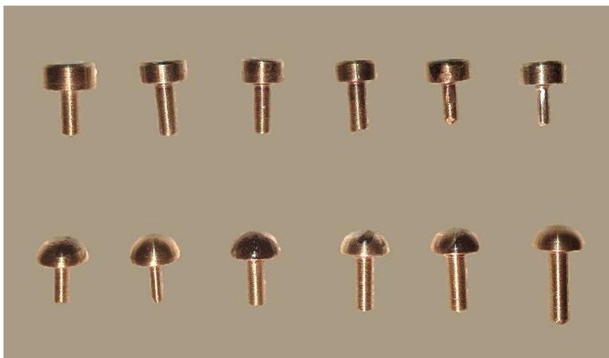
Slika 11. Čavlići za prijenos opterećenja (gore – s ravnom površinom, dolje – s polukuglastom površinom)
