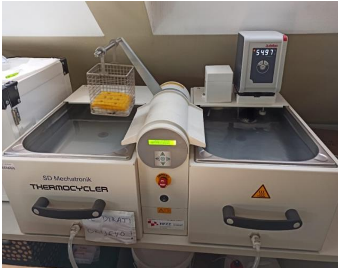
Slika 4. Uređaj za termocikliranje THE 1200 (SD Mechatronik, Feldkirchen-Westerham, Njemačka).
