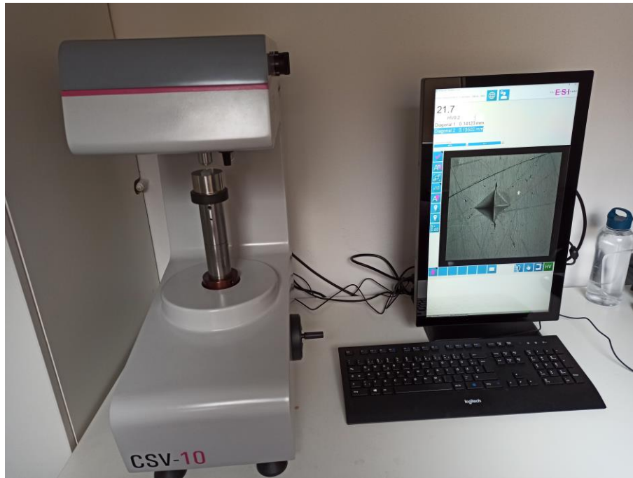
Slika 6. Uređaj za mjerenje mikrotvrdoće CSV-10 (ESI Prüftechnik GmbH, Wendlingen, Njemačka).
