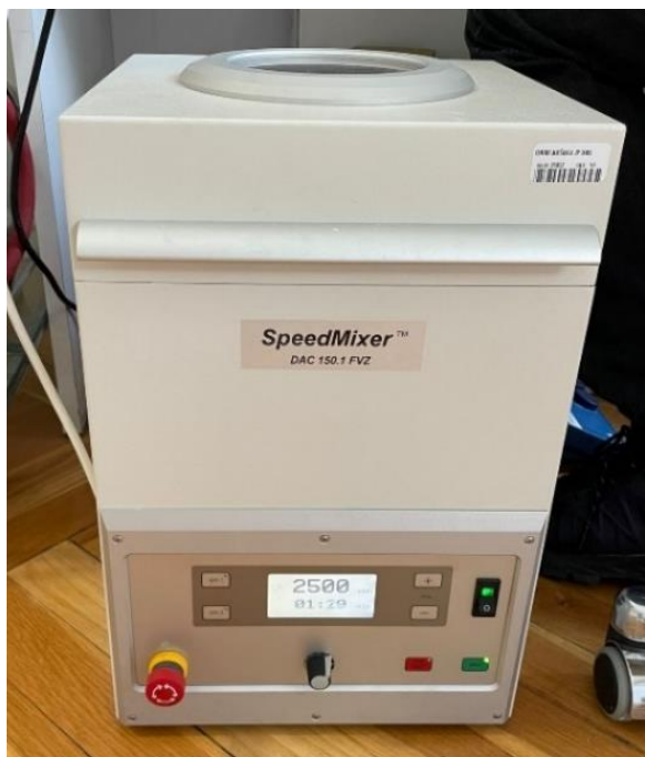
Slika 2. Centrifugalna miješalica SpeedMixer DAC 150 (Hauschild, Hamm, Njemačka).
