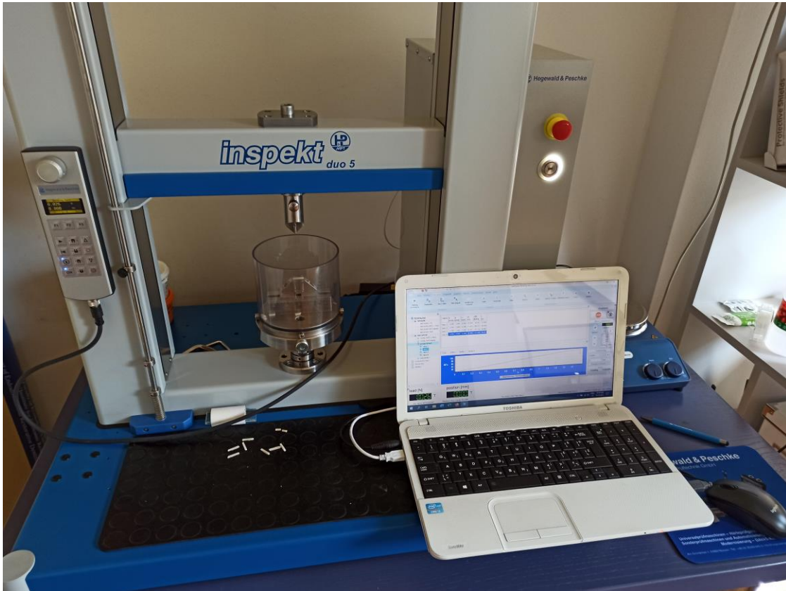
Slika 5. Univerzalni uređaj za testiranje mehaničkih svojstava Inspekt Duo 5kN-M (Hegewald & Peschke, Nossen, Njemačka).
