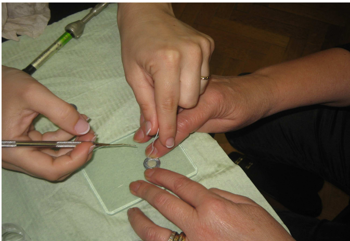
Slika 8. Izrada diskova iz kompozitnog materijala
