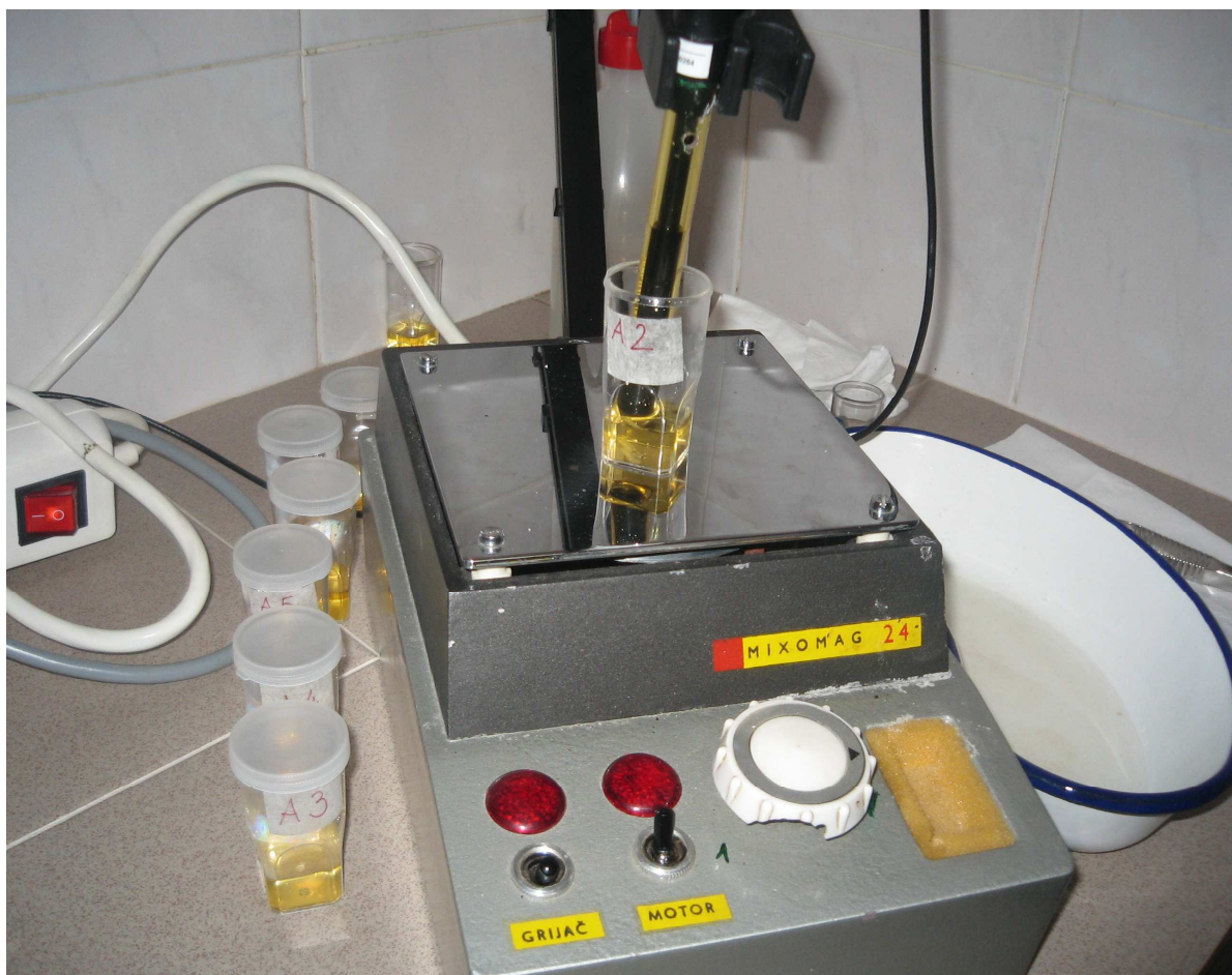
Slika 13. Mjerenje ion - selektivnom elektrodom
