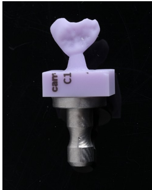
Slika 11. Staklokeramički litij-disilikatni onlay izravno nakon glodanja, prije obrade i kristalizacije
