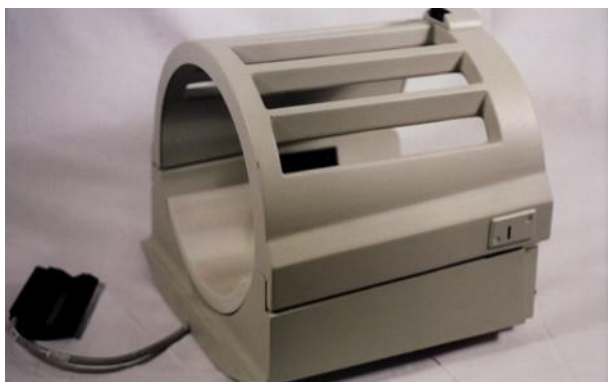
Slika 3. Gradijentna zavojnica. Preuzeto: doc. dr. sc. Dijana Zadravec, arhiva
