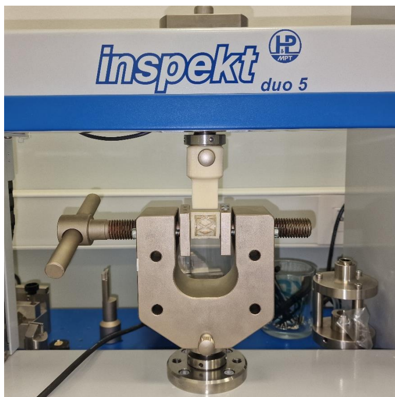
Slika 30. Test lateralne kompresije na uređaju Inspekt table 50 kN.
