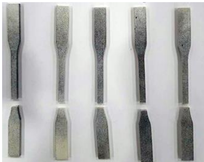
Slika 38. Lokacije loma uzoraka orijentacije 2 (bočne).
