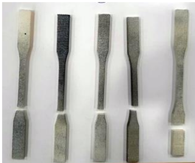
Slika 41. Lokacije loma uzoraka iz orijentacije 3 (uspravne).
