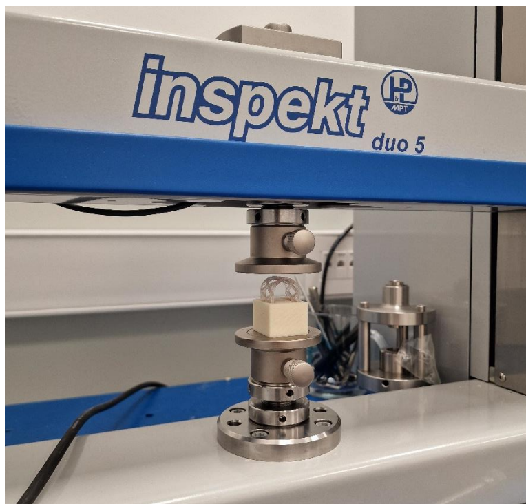
Slika 29. Test okluzalne kompresije na uređaju Inspekt table 50 kN.
