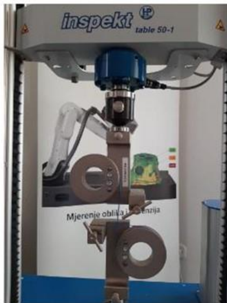
Slika 7. Statički vlačni pokus sirovog MakerBot Method PLA filameta.
