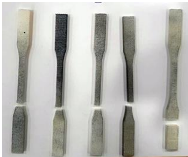
Slika 41. Lokacije loma uzoraka iz orijentacije 3 (uspravne).
