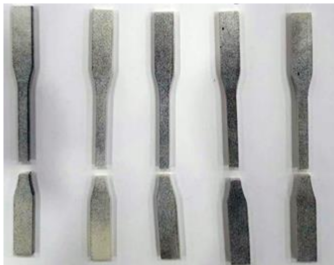
Slika 38. Lokacije loma uzoraka orijentacije 2 (bočne).
