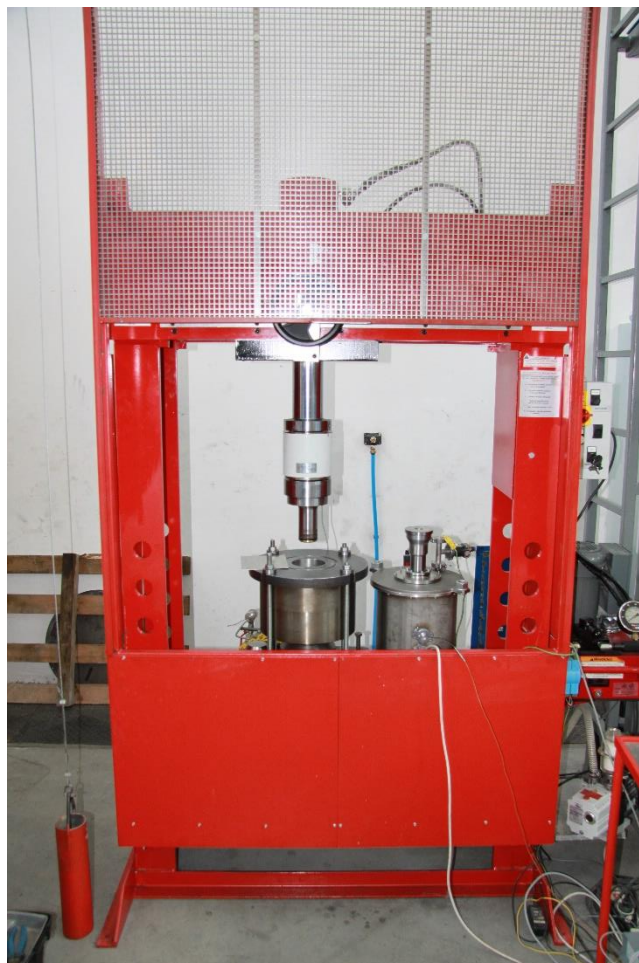
Slika 28. Preša za CIP postupak
