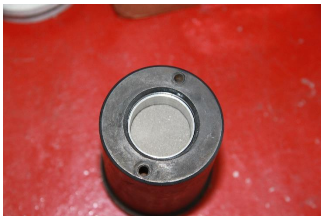
Slika 27. Titanov prah u kiveti i pripremljen za tlačenje
