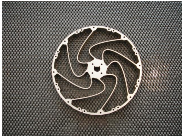
Slika 22. Složeni oblici dobiveni upotrebom EDM-a (preuzeto iz 112)
