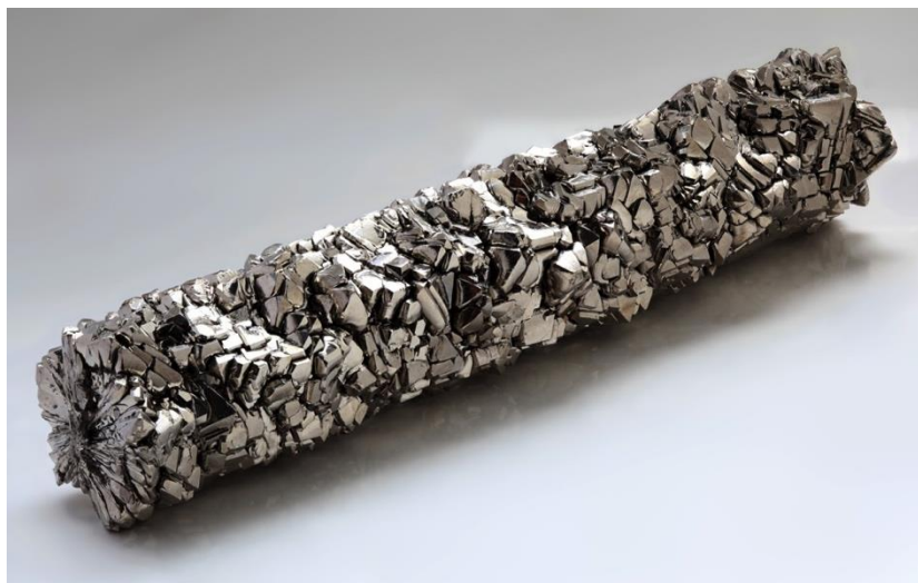
Slika 14. Šipka kristaliziranog titana, visoke čistoće 99.995 % (preuzeto iz 78)
