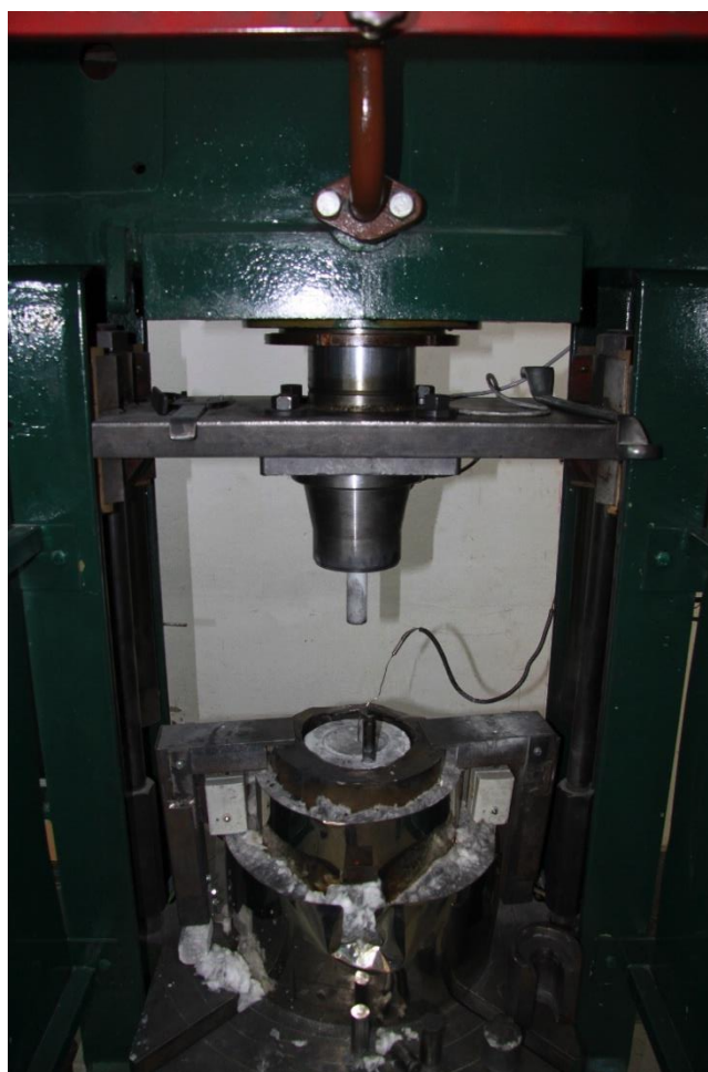
Slika 30. Preša za ekstruzijski postupak
