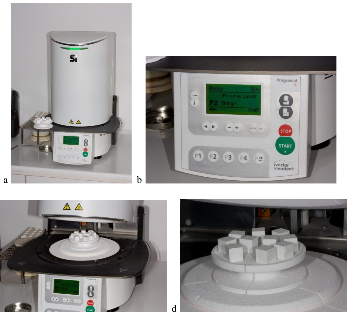
Slika 30.a,b,c,d. Sinteriranje blokova cirkonijevog oksida.
