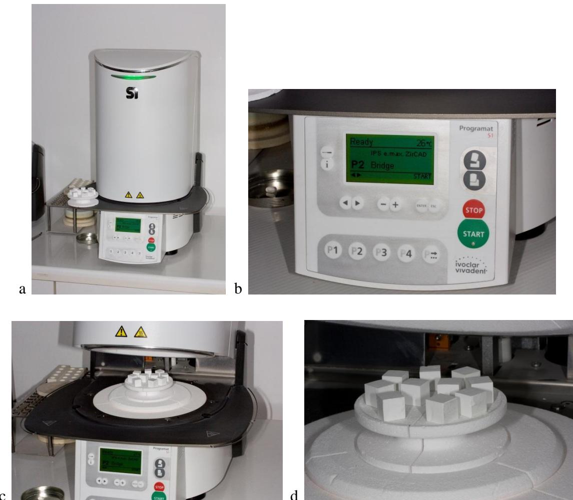
**Slika 30.a,b,c,d.** Sinteriranje blokova cirkonijevog oksida.
