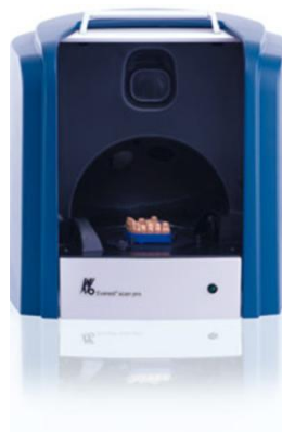
Slika 11. Everest scan pro skener (preuzeto iz 98).
