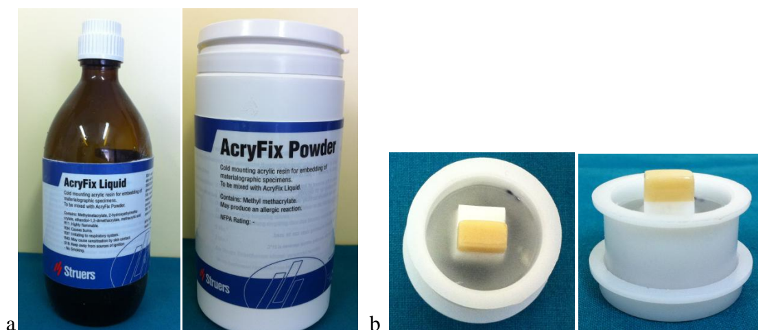
Slika 50. a) hladnopolimerizirajuća smola za fiksaciju uzoraka b) uzorci fiksirani u kalupe
