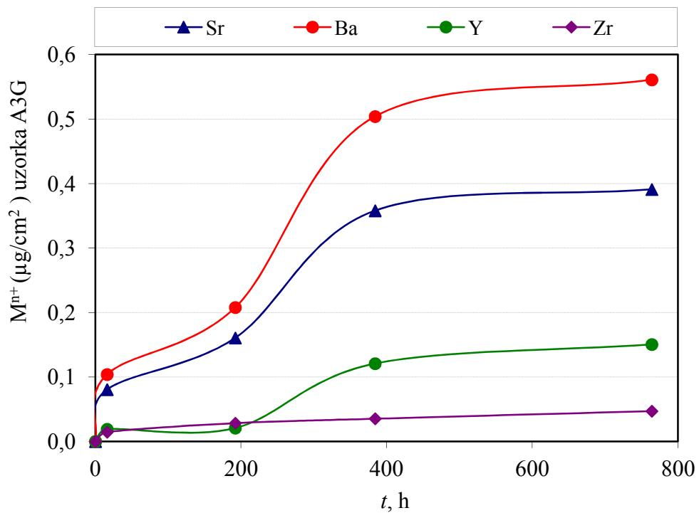
Slika 46. Usporedba količina  $\text{Sr}^{2+}$ ,  $\text{Ba}^{2+}$ ,  $\text{Y}^{3+}$  i  $\text{Zr}^{4+}$  eluiranih iona iz zubne keramike (uzorak A3G) u 4%-tnoj  $\text{CH}_3\text{OOH}$  otopini kao funkcija vremena izloženosti.
