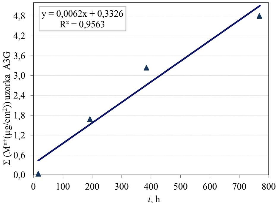
Slika 52. Linearna ovisnost kvadrata ukupne količine eluiranih iona iz zubne keramike (uzorak A3G) o vremenu, u 4%-tnoj  $\text{CH}_3\text{OOH}$  otopini, za određivanje vrijednosti parabolne konstante brzine reakcije.
