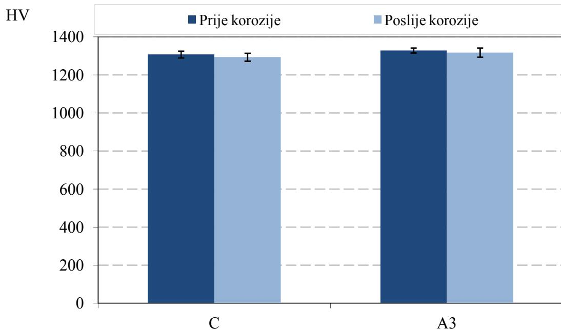
Slika 70. Usporedba vrijednosti tvrdoće (**HV3**) zubne keramike uzoraka C i A3 prije i poslije ispitivanja kemijske postojanosti u 4%-tnej vodenoj otopini octene kiseline (srednje vrijednosti i standardno odstupanje).
