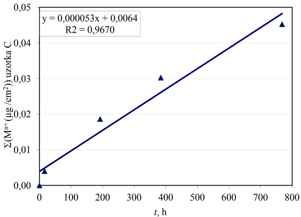
Slika 50. Linearna ovisnost kvadrata ukupne količine eluiranih iona iz zubne keramike (uzorak C) o vremenu, u 4%-tnoj  $\text{CH}_3\text{OOH}$  otopini, za određivanje vrijednosti parabolne konstante brzine reakcije.
