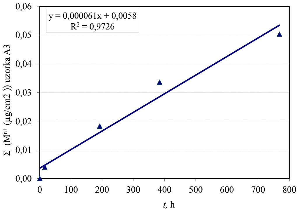
Slika 51. Linearna ovisnost kvadrata ukupne količine eluiranih iona iz zubne keramike (uzorak A3) o vremenu, u 4%-tnoj  $\text{CH}_3\text{OOH}$  otopini, za određivanje vrijednosti parabolne konstante brzine reakcije.
