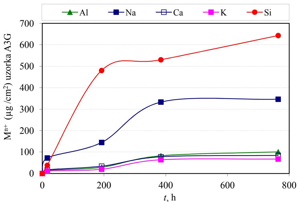
Slika 44. Usporedba količine eluiranih iona  $\text{Al}^{3+}$ ,  $\text{Na}^+$ ,  $\text{Ca}^{2+}$ ,  $\text{K}^+$  i  $\text{Si}^{4+}$  iz zubne keramike (uzorak A3G) u 4%-tnoj  $\text{CH}_3\text{OOH}$  otopini kao funkcija vremena izloženosti.
