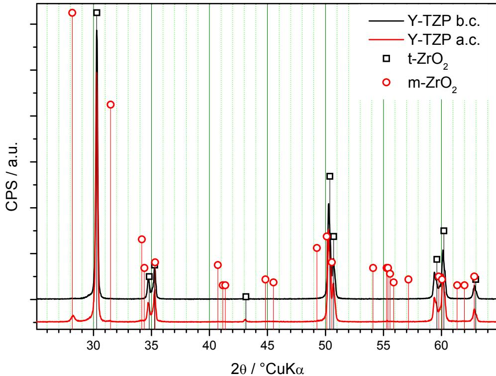
Slika 39. Usporedba difraktograma uzorka C prije i poslije korozije.
