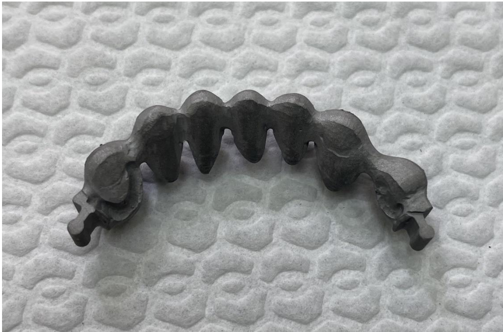
Slika 4. Fiksna konstrukcija (most) dobivena konvencionalnim postupkom lijevanja
