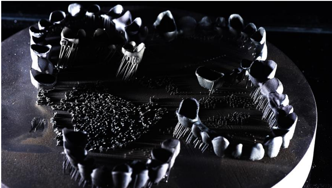
Slika 12. 3D građene metalne konstrukcije fiksnoprotetskih nadomjestaka
