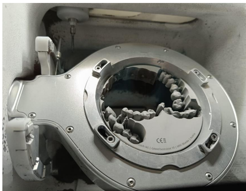
Slika 10. Disk kobalt-krom legure poslije postupka glodanja
