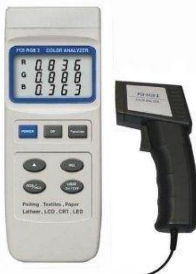
Slika 28. Kolorimetar (PCE RGB2 Color analyzer, PCE Group, Njemačka).
