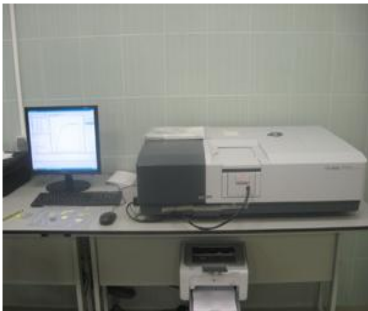
Slika 29. UV/VIS NIR spektrofotometar (3600, Shimadzu, Japan).
