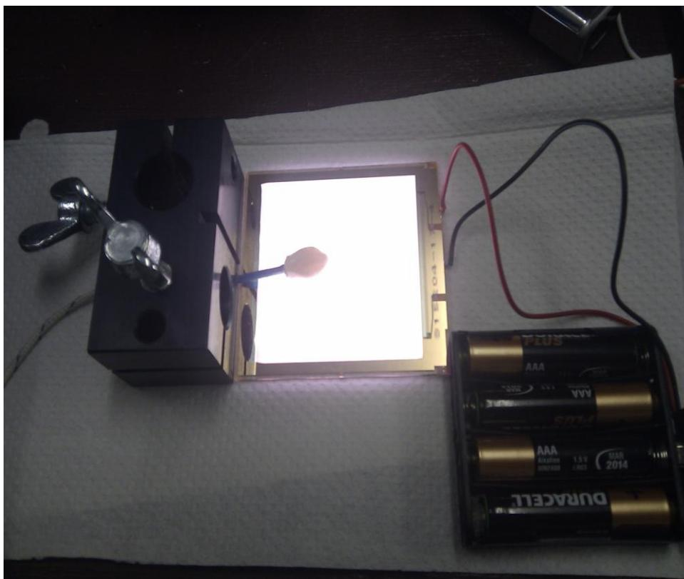
Slika 16. OLED izvor svjetlosti (PPML, Pescara, Italija).
