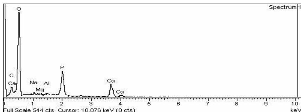
Slika 26. Prikaz mjerena EDS analizom.
