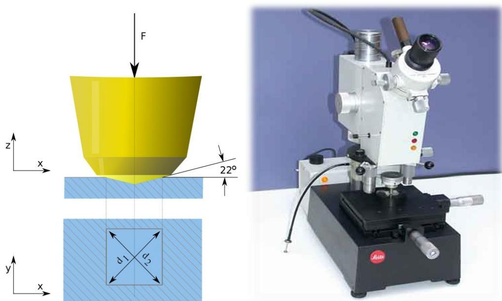
Slika 24. Uređaj za mjerjenje mikrotvrdoće.
