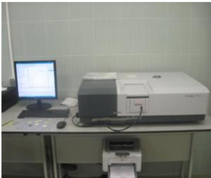
Slika 29. UV/VIS NIR spektrofotometar (3600, Shimadzu, Japan).
