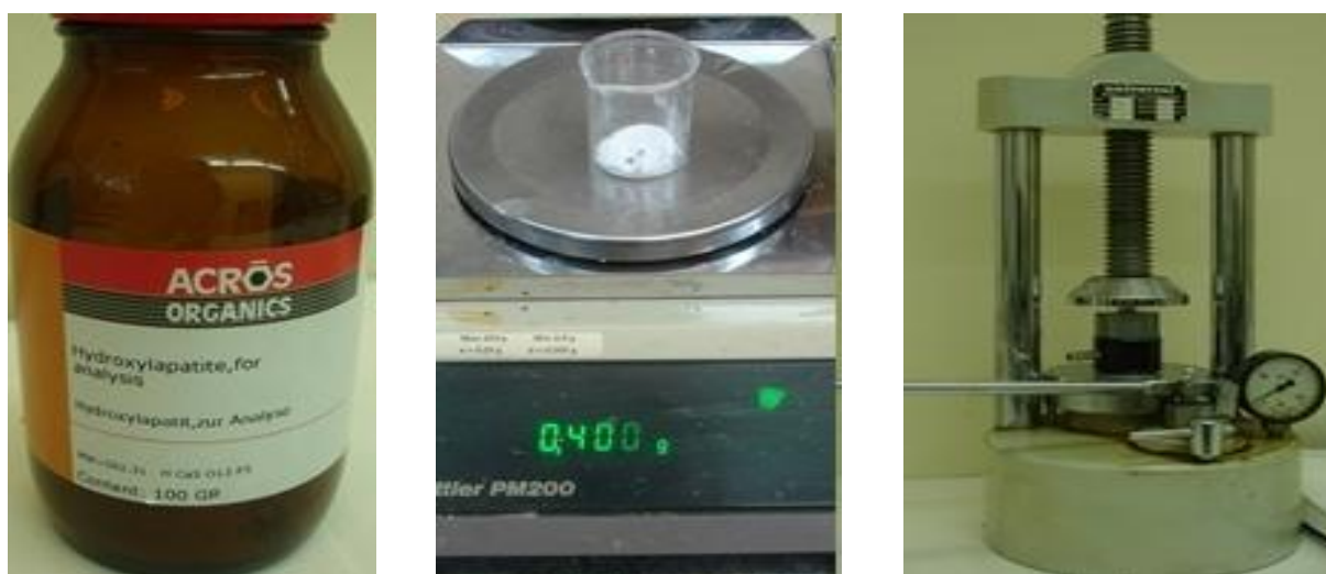
Slika 21. Priprema pastila hidroksilapatita.
