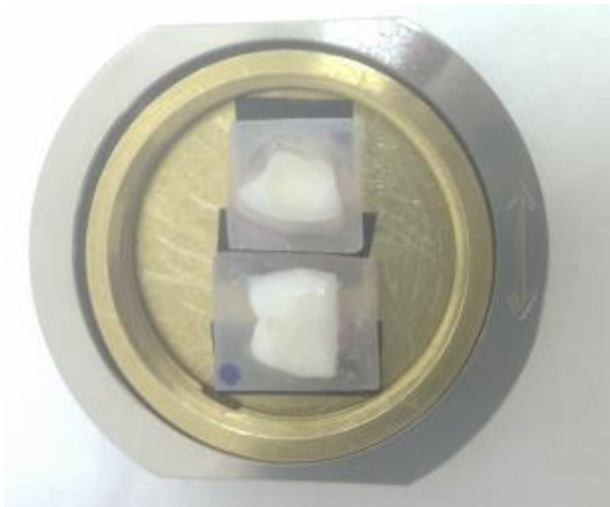
Slika 20. Uzorci cakline i dentina za SEM i EDS analizu.
