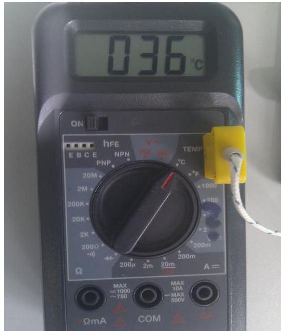
Slika 23. Digitalni termometar (Termopar Digital Multimeter, Tektronix DMM 916, USA).
