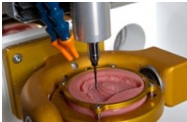
Slika 19. Glodalica AvaDent CAD/AM sustava. Preuzeto iz:(8).
