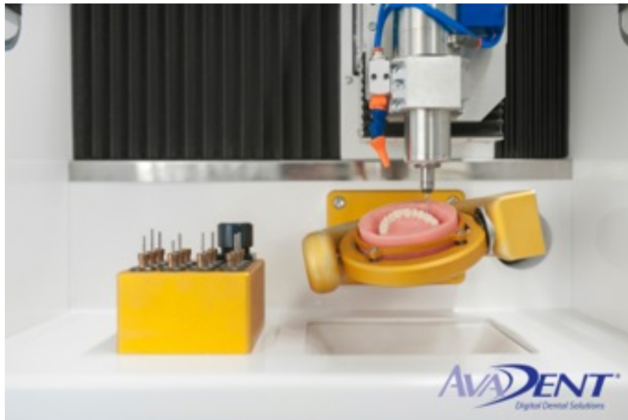
Slika 1. AvaDent CAD/CAM sustav za izradu potpunih proteza. Preuzeto iz: (8).
