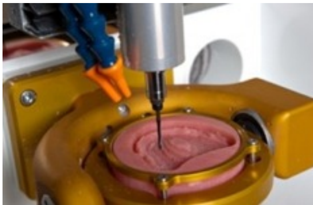
Slika 19. Glodalica AvaDent CAD/AM sustava. Preuzeto iz:(8).
