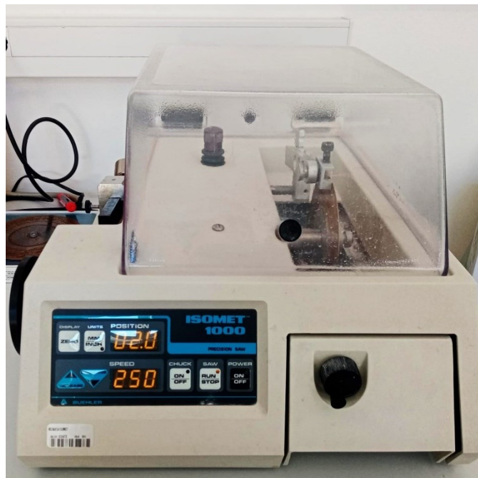
Slika 6. Isomet pila za rezanje uzoraka.
