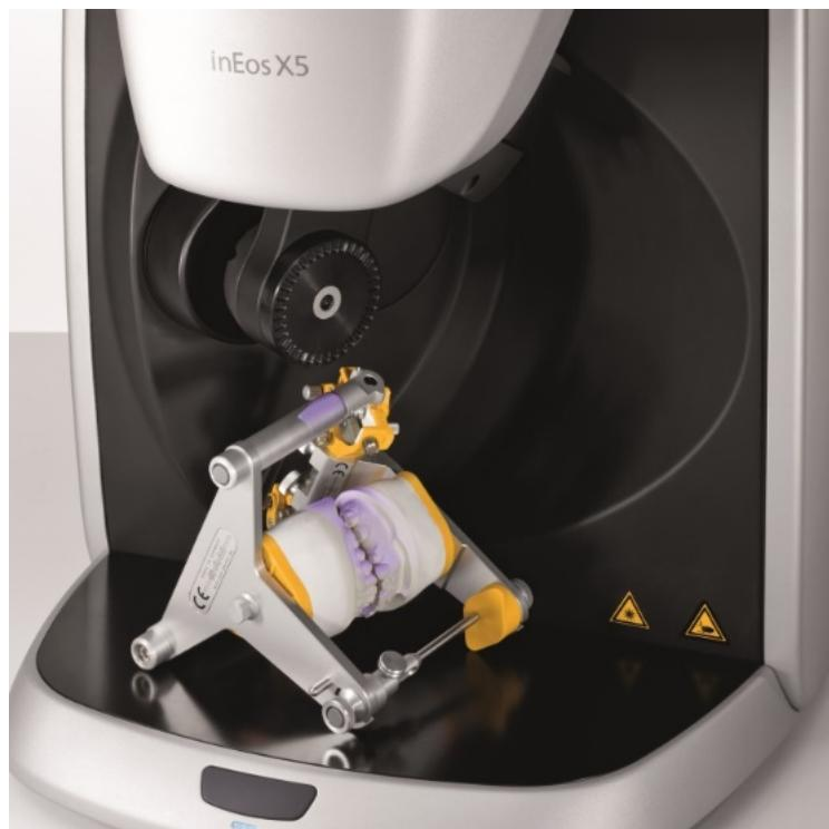
**Slika 10.** CEREC® InEos uređaj za optičku digitalizaciju. Preuzeto iz: (34)
