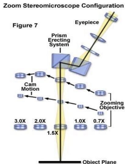
Slika 8. Konfiguracija stereomikroskopa sa zoom sustavom. Preuzeto: (9)
