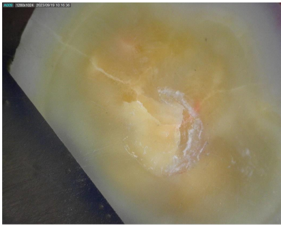
Slika 40. Slika uzorka s mješovitom (kompozitnom) frakturom pod digitalnim mikroskopom Dino-Lite .
