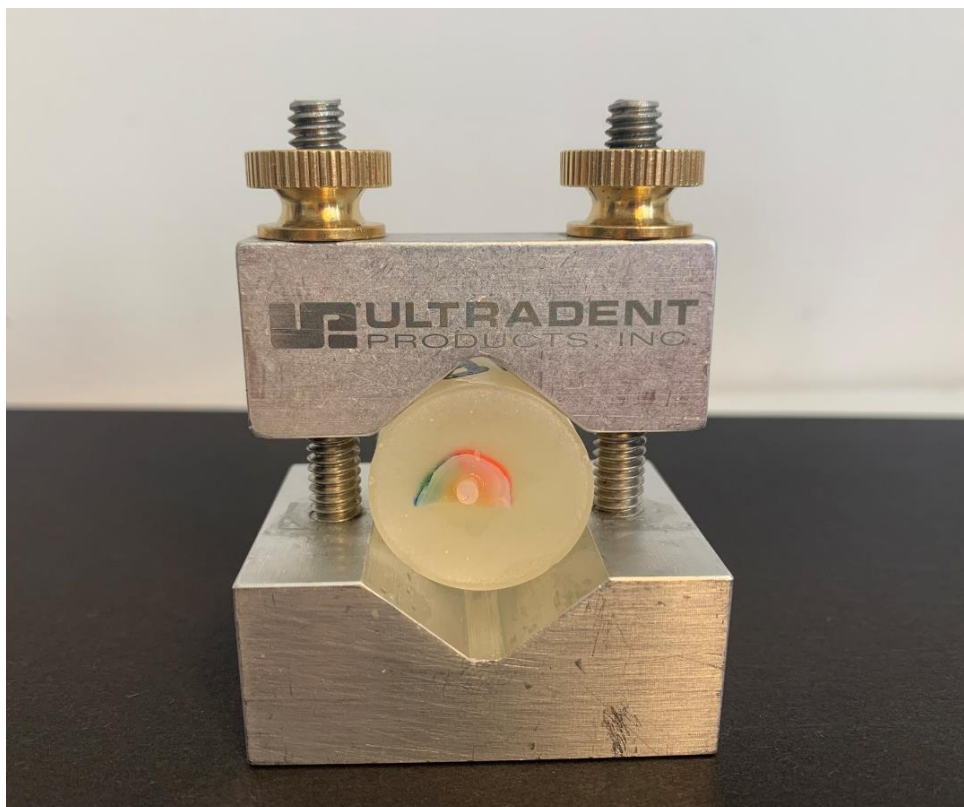
Slika 22. Uzorak u Ultradentovom držaču.
