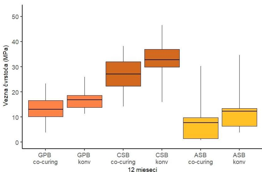
**Slika 36.** Distribucija vezne čvrstoće prikazana Box-plot dijagramima 12 mjeseci nakon tretmana prema eksperimentalnim skupinama. *GPB, G Premio Bond; CSB, Clearfil SE Bond 2; ASB, Adper Single Bond 2; konv, konvencionalna metoda polimerizacije; co-curing, istovremena svjetlosna polimerizacija; MPa, megapaskal*
