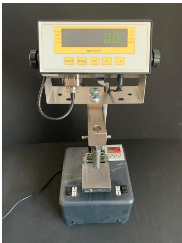
Slika 19. *UltraTester* stroj za ispitivanje vezne čvrstoće.
