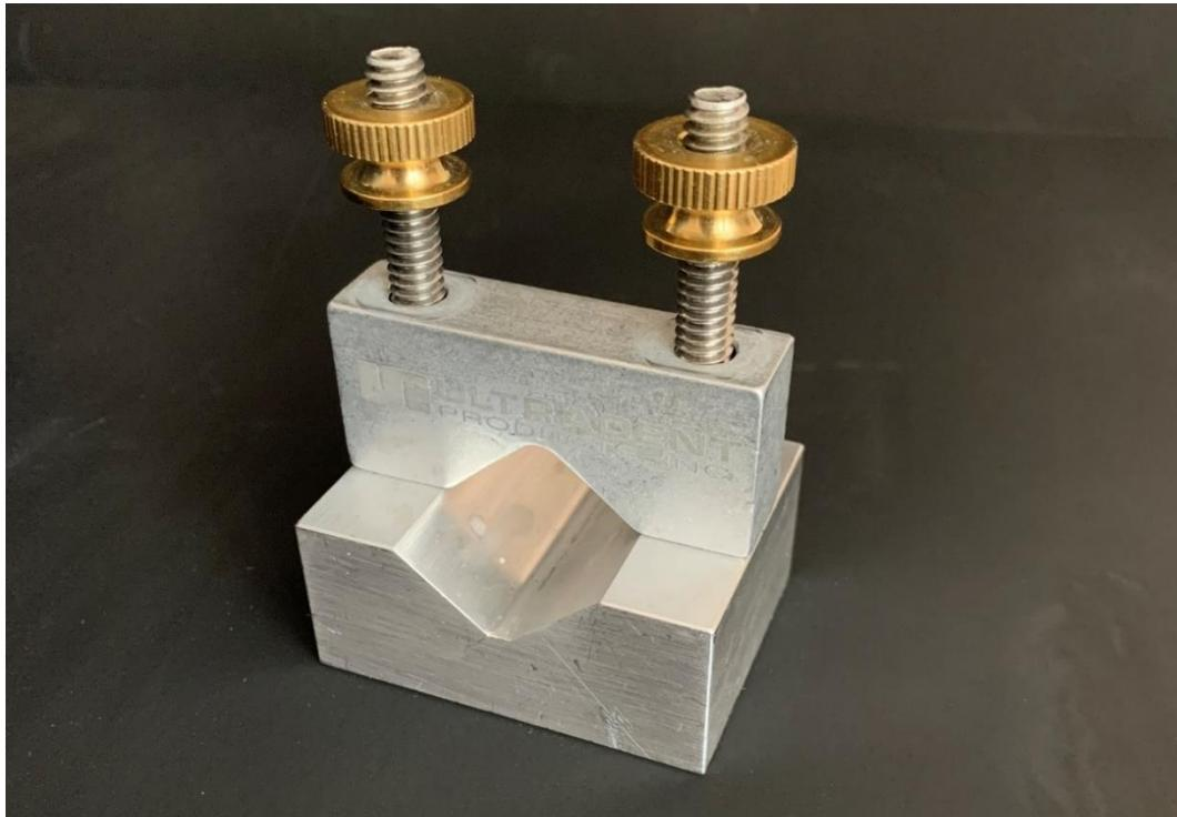
**Slika 21.** Držač uzorka prilikom testiranja vezne čvrstoće u *UltraTesteru*.
