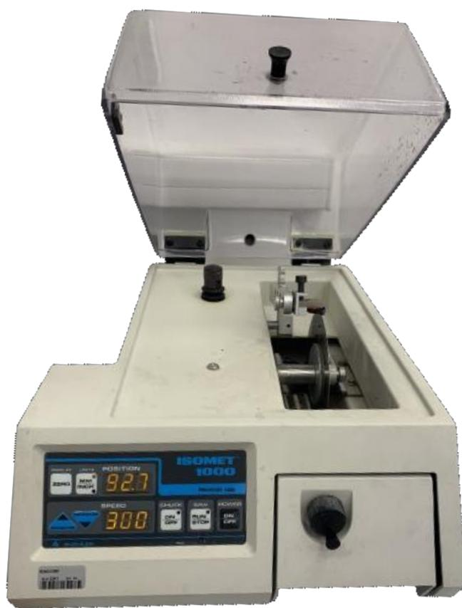
**Slika 2.** *Buehler IsoMet 1000* precizna rezalica s dijamantnim diskom
