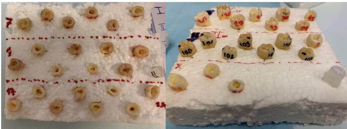
Slika 20. Dio uzoraka pripremljen za mikro-CT snimanje. Nakon svake eksperimentalne faze uzorci su vraćani u točno određene pozicije i potom snimani.
