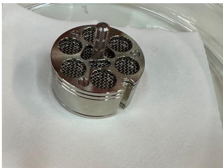
Slika 35. Uzorci pripremljeni u nosaču za SEM snimanje i analizu
