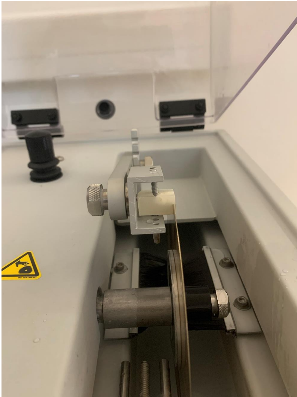
Slika 26. Rezanje dentinskih pločica debljine 1 mm na Isomet pili (Isomet 1000, Buehler, Illinois, USA)
