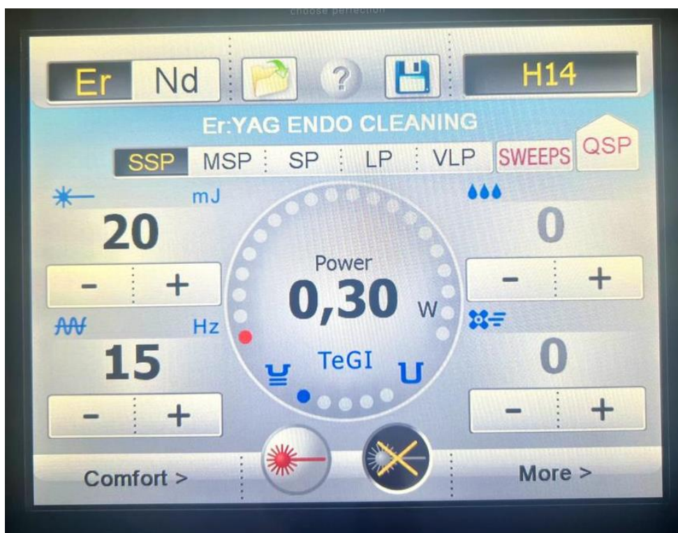
Slika 16. Postavke Er:YAG lasera za Super Short Pulse (SSP) modalitet laserski aktiviranog ispiranja
