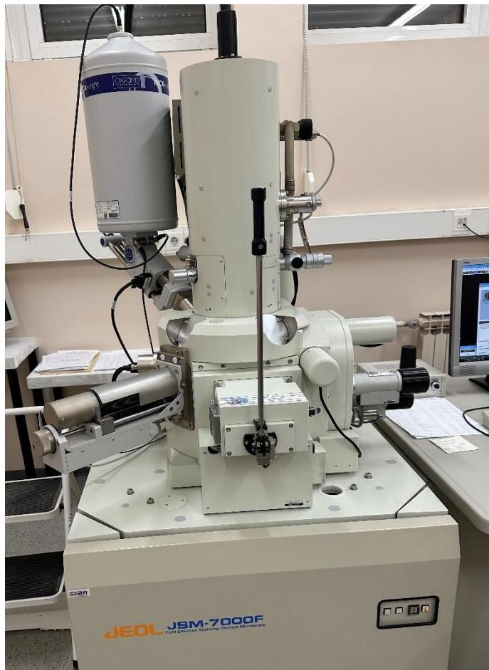
**Slika 34.** Pregledni elektronski mikroskop (JEOL JSM-7000F)
