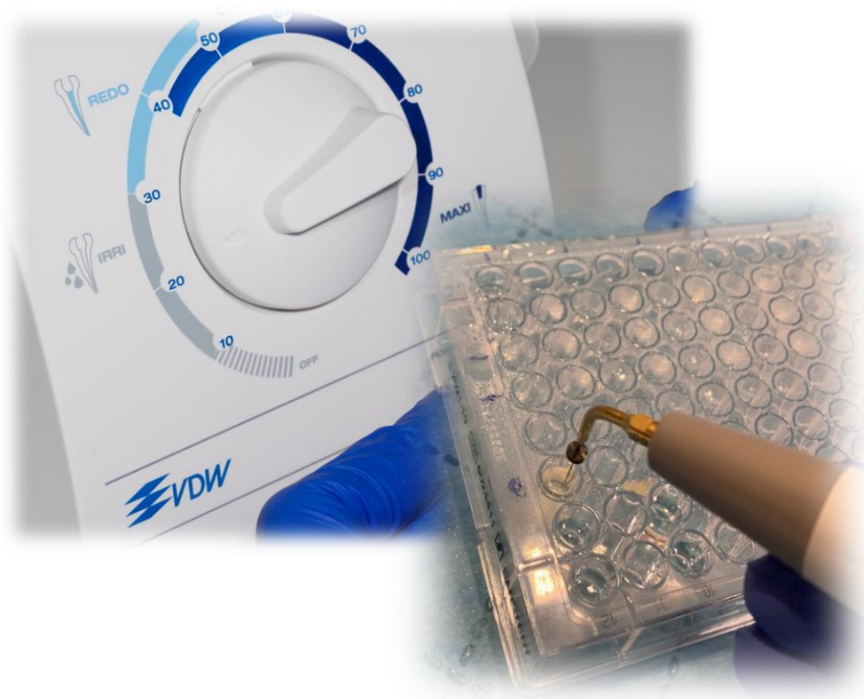
Slika 29. Ultrazvučno aktivirano ispiranje uzoraka dentinskih pločica s uzgojenim 14-dnevnim E. faecalis biofilmom
