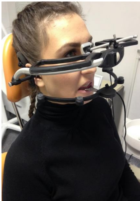
Slika 5. Kinematski obrazni luk s paraokluzijskom žlicom sustava Arcus Digma za snimanje kretnji donje čeljusti
