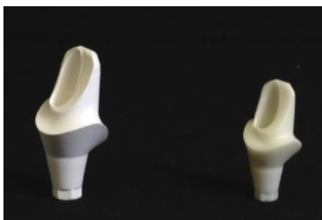
Slika 10. Bataljak prije i nakon sinteriranja. Preuzeto: (22)
