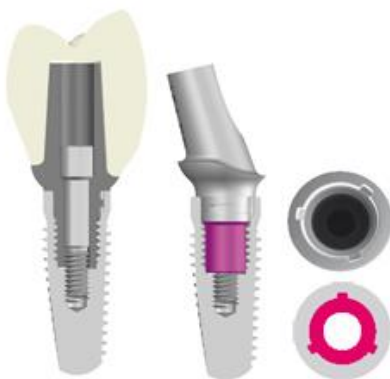
Slika 2. Cilindrični dosjed s antirotacijskim utorima. Preuzeto: (6)
