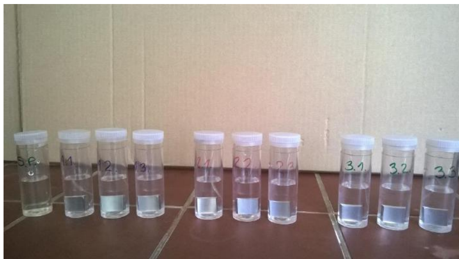
Slika 4. Postupak izlaganja uzoraka 3,8 %-tnoj otopini NaCl
