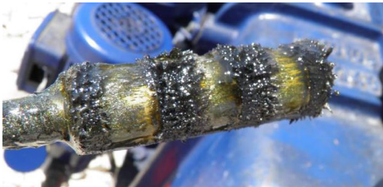
Slika 4. Nakupine metalnih čestica filtera ulja prijenosnika snage
