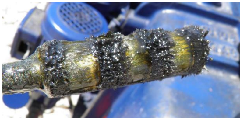
Slika 4. Nakupine metalnih čestica filtera ulja prijenosnika snage
