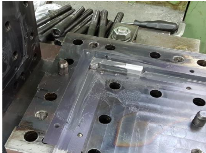
Slika 5. Uzorak u ECAP kalupu nakon provlačenja [8]
