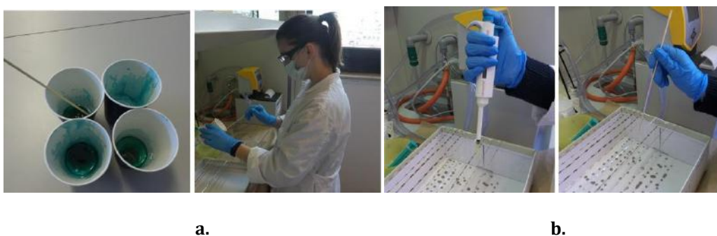
Slika 4. Priprava smole (a); nanošenje kapljica smole na vlaknati supstrat (b)
