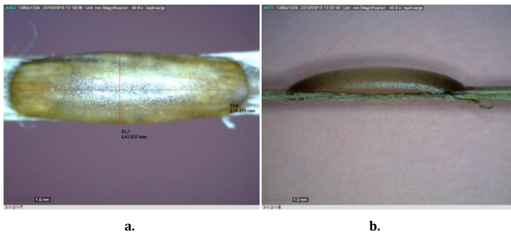
Slika 6. Mikroskopska analiza: gornje (a.) i bočne strane skrutnute kapi smole na vlaknatom supstratu (b)
