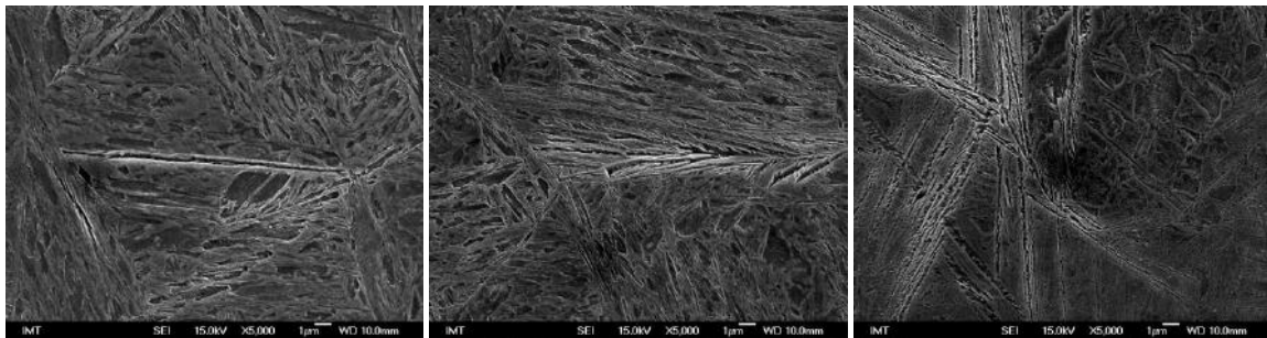
Slika 1. Uzorci šarže UA s najmanjim udjelom Mn hlađeni brzinama: a) 2,5 °C/s, b) 1,5 °C/s, c) 0,5 °C/s
