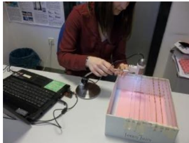
Slika 5. Provedba mikroskopiranja primjenom prijenosnog USB optičkog mikroskopa
