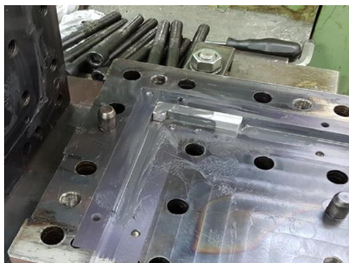
Slika 5. Uzorak u ECAP kalupu nakon provlačenja [8]
