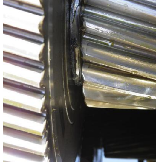
Slika broj 6. Pojava mikro - rupičenja na boku zubca
