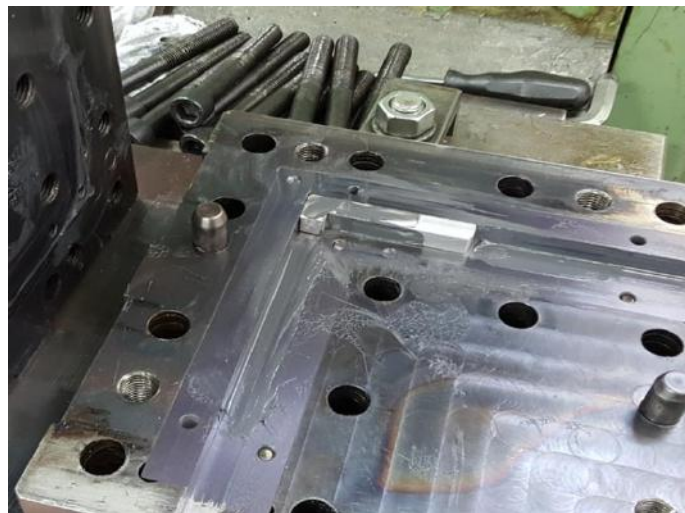
Slika 5. Uzorak u ECAP kalupu nakon provlačenja [8]
