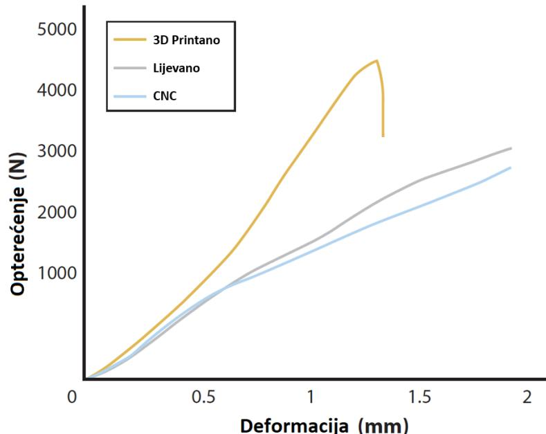
Slika 4. Grafički prikaz krivulja opterećenje - deformacija za različite načine izrade [3]
