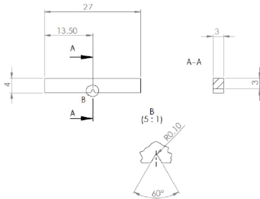
**Slika 9. Dimenzijs epruveta za ispitivanje udarnog rada loma**
