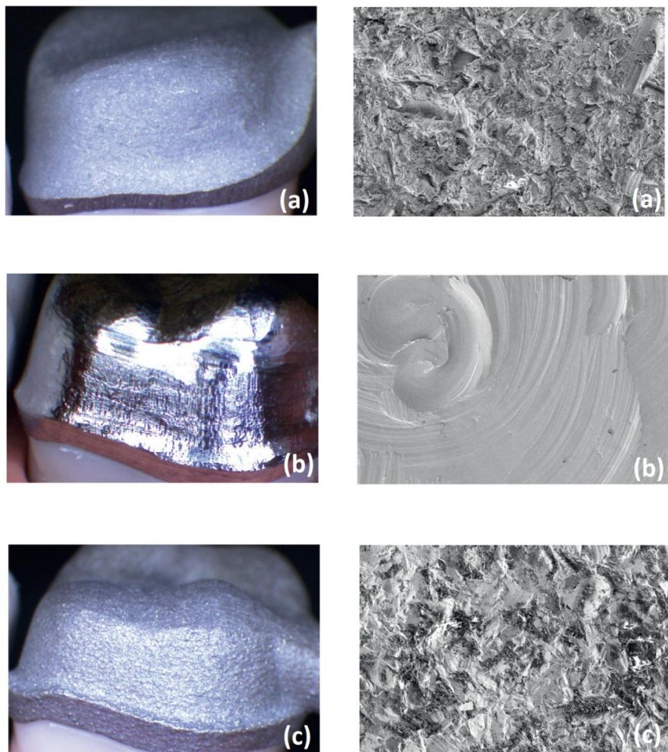
**Slika 3. Mikrostruktura Co – Cr dentalni proizvoda nakon razlilitih načina proizvodnje:
