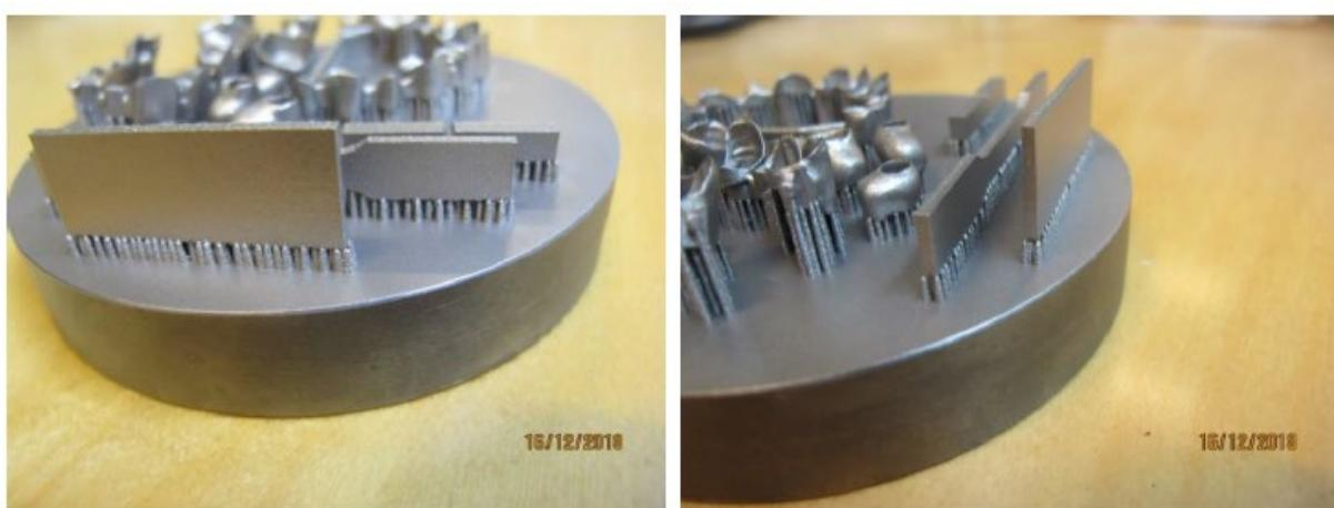
Slika 5. 3D isprintane epruvete na radnoj podlozi stroja [5]
