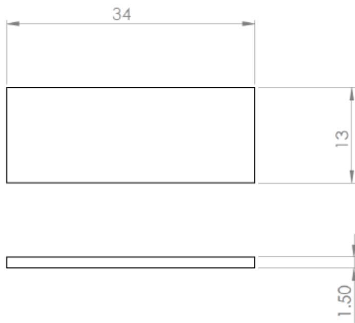
Slika 7. Dimenzije epruveta za ispitivanje savojne čvrstoće
