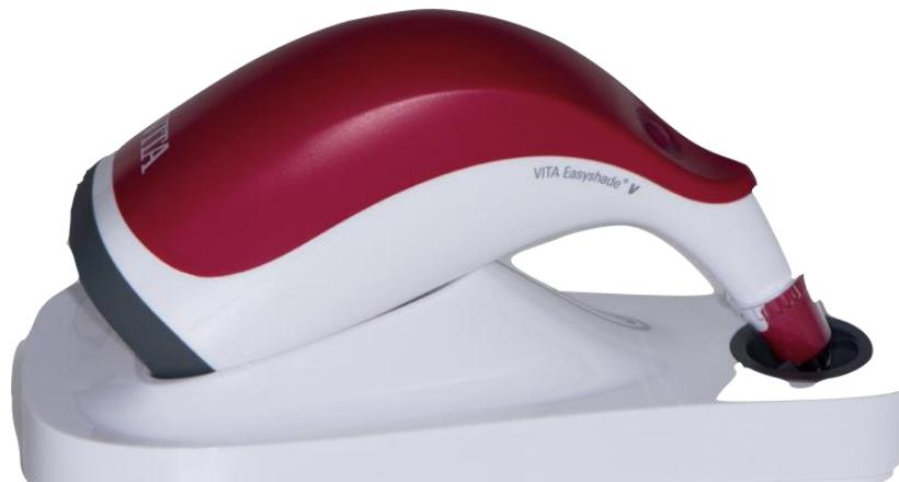
**Slika 12.** Kalibracija spektrofotometra Easyshade V
