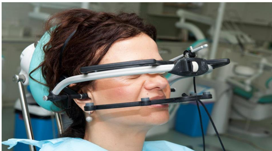
Slika 4. Primjer uređaja za snimanje kretnji donje čeljusti na temelju šest stupnjeva slobode (ultrazvučni princip).
