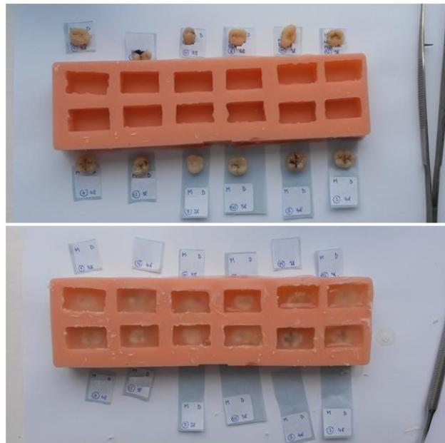
Slika 3. Uklapanje uzoraka u bezbojni samopolimerizirajući akrilat
