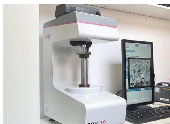
Uređaj za mjerjenje mikrotvrdoće
