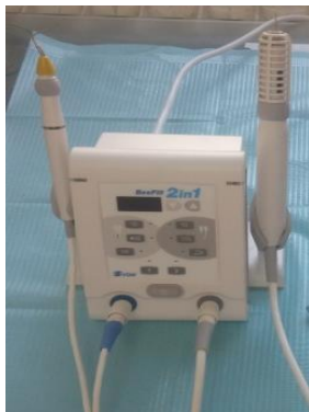
Slika 32. BeeFill (dva u jedan uređaj za punjenje kanala vrućom vertikalnom kondenzacijom i injekcijskom tehnikom).
