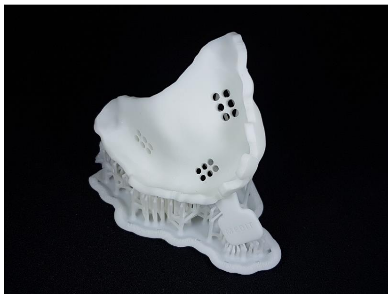
Slika 10. 3D printana individualna žlica potpornim elementima vezana za postolje.
