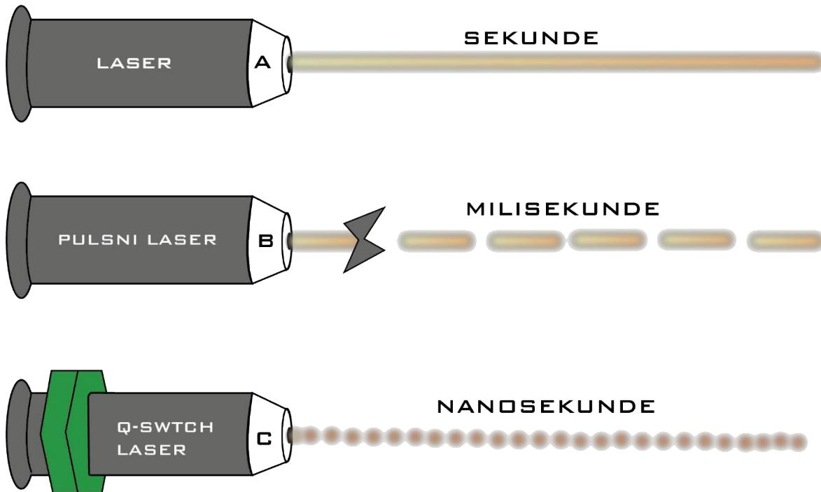
Slika 5. Kontinuirani rad lasera naspram pulsнog načina rada. A) Kontinuirani, B) Pulsni laser, C) Q-switch laser
